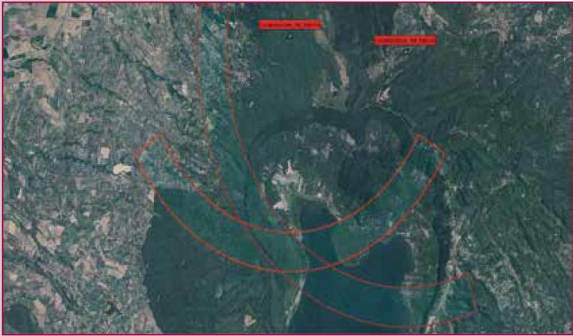
**Figura 41:** Esempio di elaborazione cartografica di un tracciato utile per la localizzazione di persone disperse mediante analisi delle coperture delle celle per la telefonia mobile.
