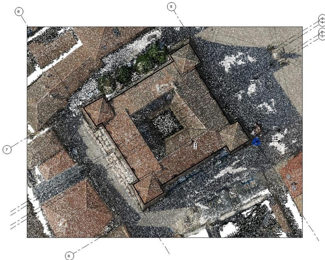
**Figura 111:** Inserimento di assi fissi e griglie nella vista planimetrica della nuvola di punti della Castellina –
