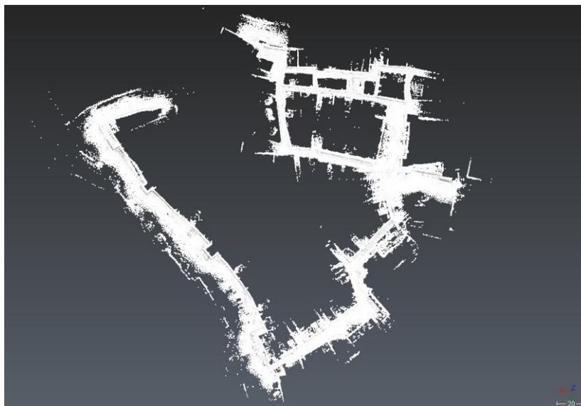
**Figura 82:** Esempio di nuvole di punti generate dallo strumento Zeb Revo RT relativo ad una parte della Zona Rossa di Norcia (tre missioni di scansioni unite) – 3DReshaper.
