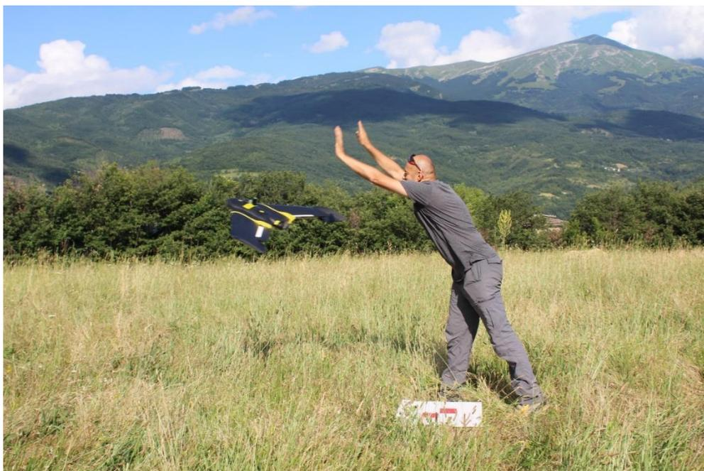
**Figura 75:** Fase di lancio del drone eBee.
