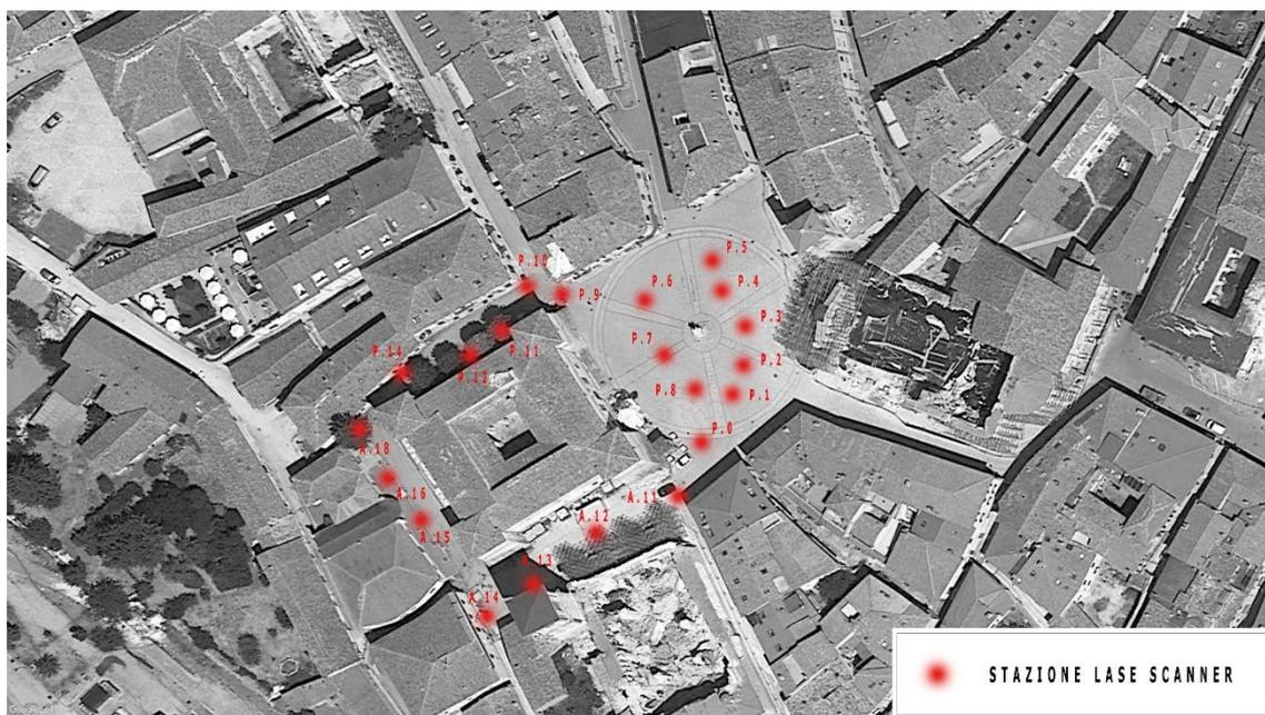
**Figura 78:** Posizionamento dei laser scanner da cui sono state eseguite le scansioni.
