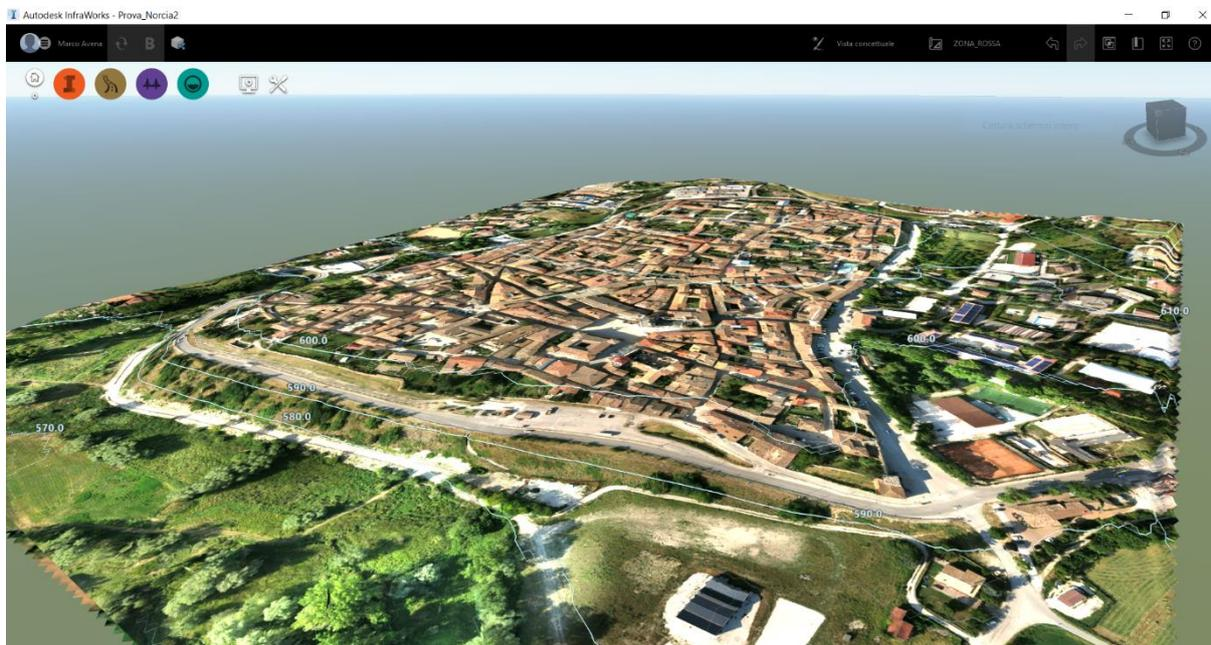
**Figura 147:** Ortofoto generata a partire dai dati acquisiti dalla fotogrammetria aerea (volo eBee) e sovrapposizione al terreno – Autodesk Infracworks 2018.
