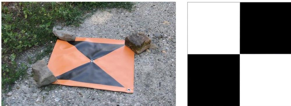
**Figura 71:** Target utilizzati per il rilievo aerofotogrammetrico del drone *eBee*.
