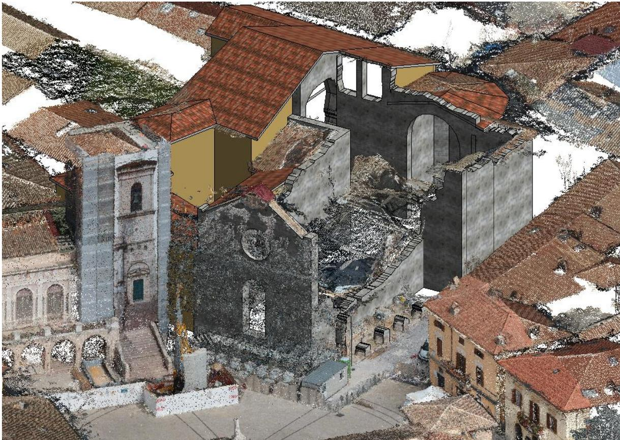
**Figura 139:** Vista assometrica della Basilica di S. Benedetto e sovrapposizione del modello BIM alla nuvola di punti – Autodesk Revit 2017.
