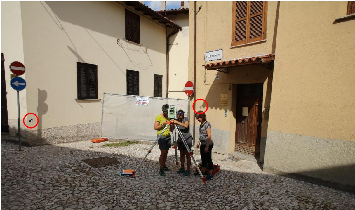
**Figura 70:** Fase di collimazione dei target con Stazione Totale ed esempio di target posizionati sulle facciate dell'edificio della Zona Rossa.
