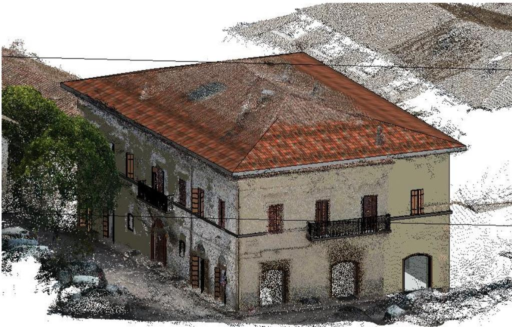
**Figura 136:** Vista assonometrica dell'edificio 2 e sovrapposizione del modello BIM con la nuvola di punti – Autodesk Revit 2017.
