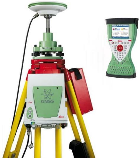
**Figura 20:** Immagine rappresentante un dispositivo Leica Viva GNSS con Ricevitore GS10 e relativo dispositivo di comando.
