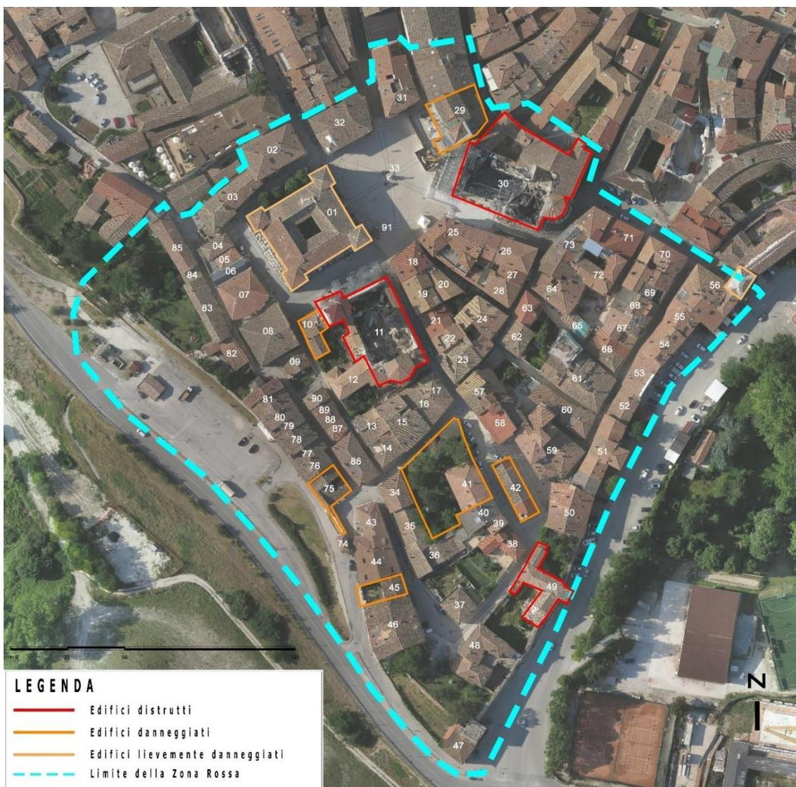
**Figura 159:** Ortofoto generata a partire dal volo *eBee* della ZR di Norcia con numerazione edifici ed individuazione del livello di danno in cui vertono gli stessi secondo la classificazione fornita da Copernicus EMS.
