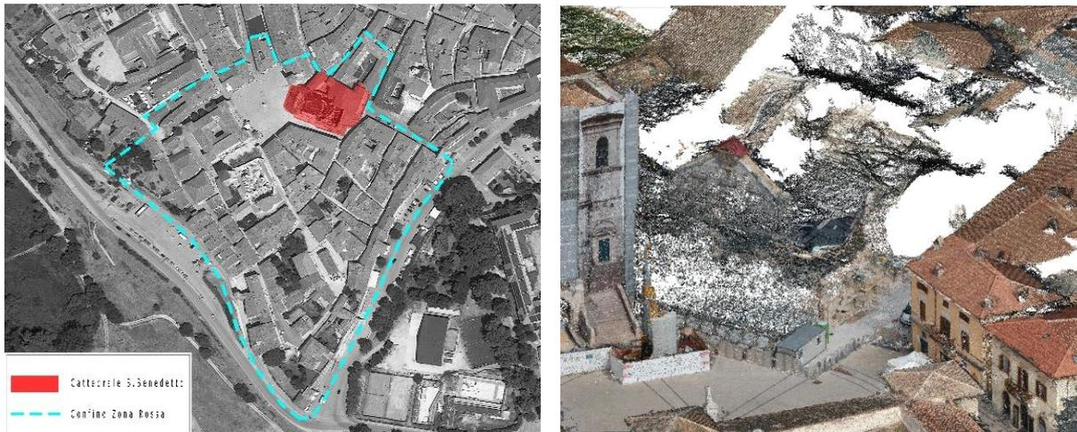
**Figura 137:** Localizzazione edificio 30, ovvero la Basilica di S. Benedetto, e porzione della nuvola di punti generata dal volo eBee e Spark che evidenzia i principali crolli del complesso – Autodesk Revit 2017.
