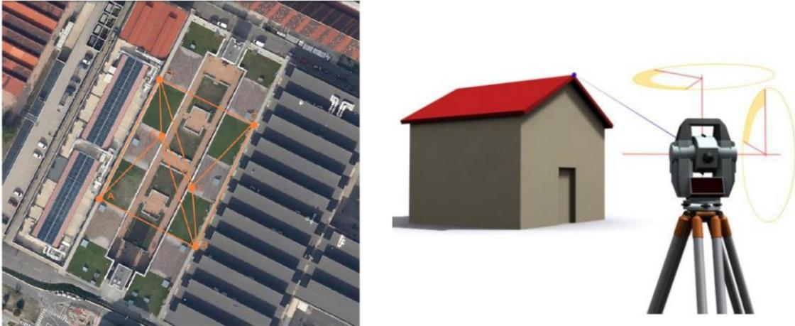
**Figura 17:** L'immagine raffigura un esempio di rete topografica relativa alle Aule I del Politecnico di Torino (a) e successivamente una schematizzazione del processo celerimetrico (b).
