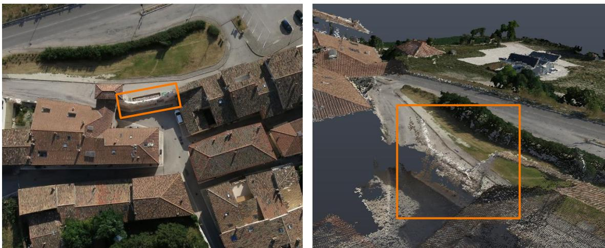
**Figura 161:** Individuazione dei danni subiti da una porzione delle mura sud della città di Norcia da immagine nadirale del volo eBee (sinistra) e da nuvola di punti unita del volo eBee e Spark DJI (destra).
