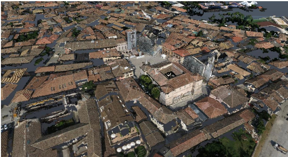
**Figura 110:** Vista della nuvola di punti completa di Norcia generata dall'unione della nuvola generata dal volo *eBee* e dal volo *Spark DJI* – Autodesk ReCap.
