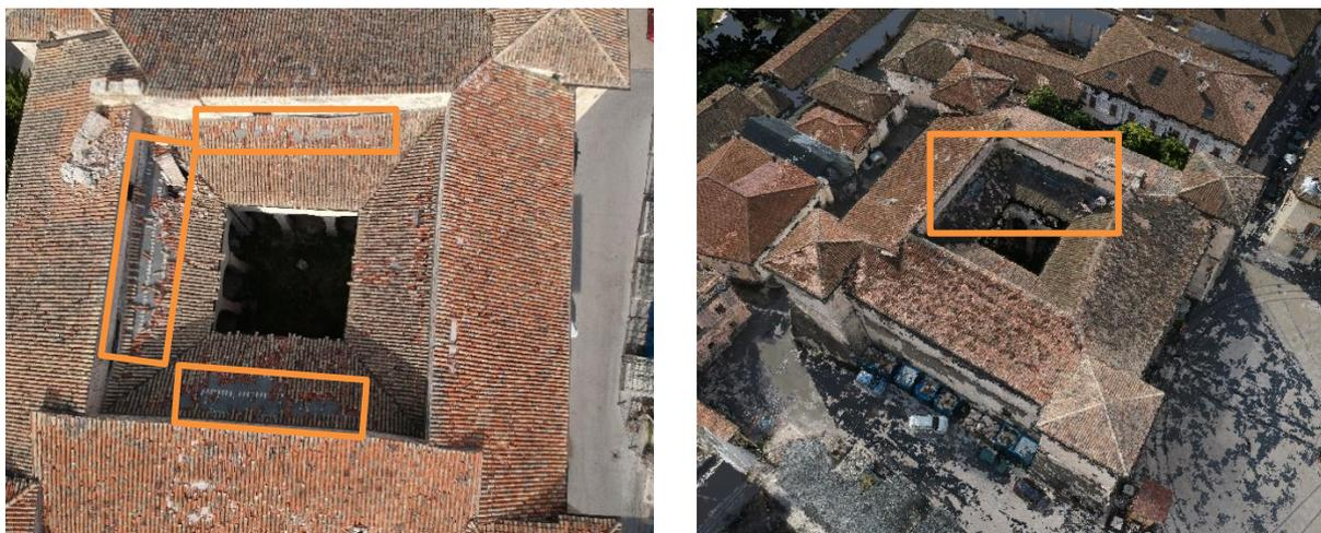
**Figura 162:** Individuazione delle assenze materiche presenti sulla copertura del chiostro interno della Castellina da immagine nadirale del volo Spark DJI (sinistra) e da nuvola di punti unita del volo eBee e Spark DJI (destra).
