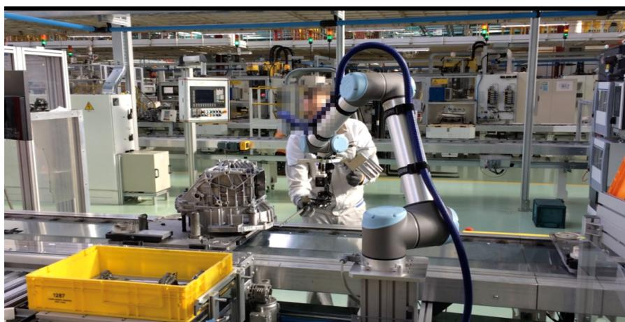
**Figura 20 - Istantanea HRC del montaggio asta parking nello stabilimento di Verrone (cortesia FCA Italy S.p.a.)**
