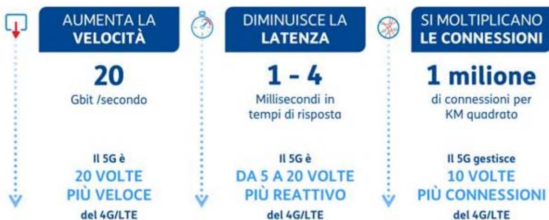
FIGURA 3. GLI ELEMENTI DELL'UPGRADE 5G (FONTE: INTERNA TIM)
