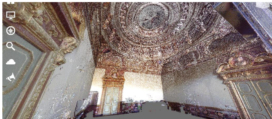
Figura 90 – Nuvola di punti: vista interna della Sala delle Rose dopo il processo di pulizia
