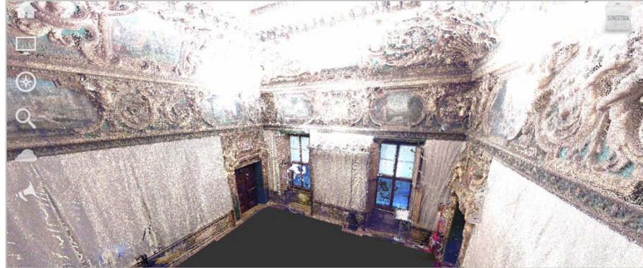
Figura 89 – Nuvola di punti: vista interna della Sala Verde dopo il processo di pulizia
