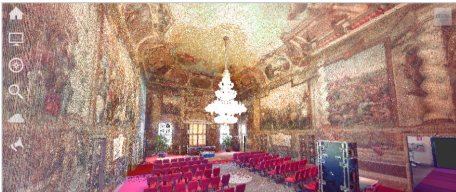
Figura 88 – Nuvola di punti prima del processo di pulizia: vista interna del Salone d'Onore
