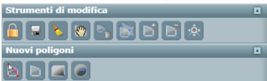
Figura 87– Strumenti per la creazione e la modifica dei poligoni contenuti nelle maschere. Strumenti di modifica (da sinistra): Rilascia lock, Salva, Annulla,
