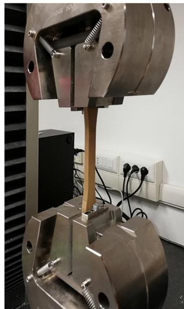
**Figura 34:** Postazione di lavoro per il testaggio dei provini in HBP®, Politecnico di Torino
