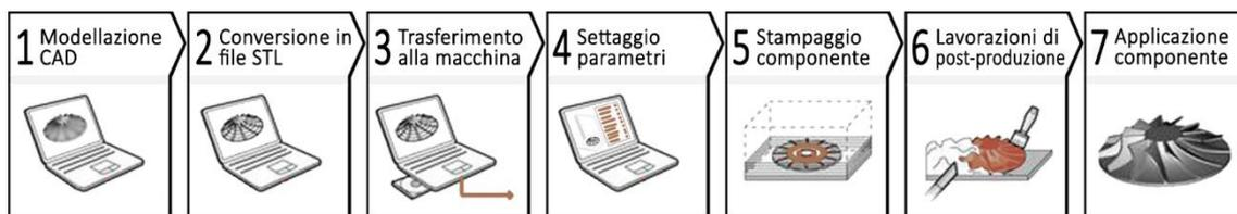
Figura 20: Schema del processo di produzione AM
