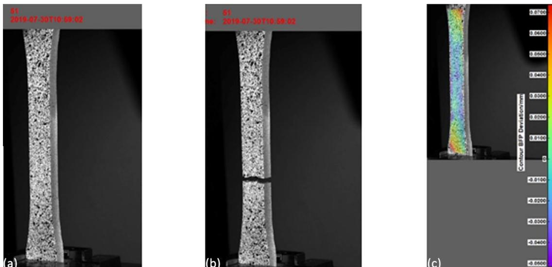
L' algoritmo di correlazione adottato si basa sul tracciamento del modello di valori di grigio negli intorni locali.  $G(x, y)$  è il valore di grigio di un pixel con coordinate  $x$  e  $y$ , facente parte di un sottoinsieme o sfaccettatura, di cui l'algoritmo di correlazione ha minimizzato la risoluzione:
