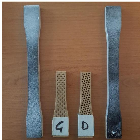
Figura 46: Provini in HBP® una volta applicato lo strato di vernice
