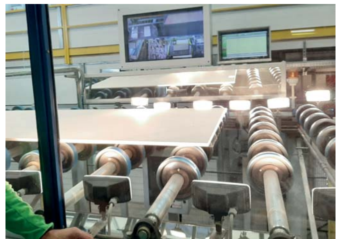
[Fig. II.32] Pannelli sottoposti a calibratura e levigatura.
