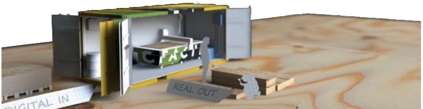
[Fig. III.31] Locale di produzione mobile Facit Homes.
