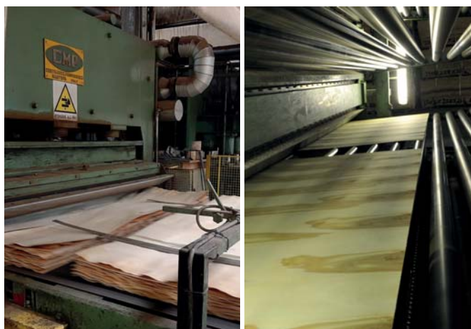
[Fig. II.28a] Pannelli nella pressa mono-vano. [Fig. II.28b] Particolare dell'interno pressa mono-vano.
