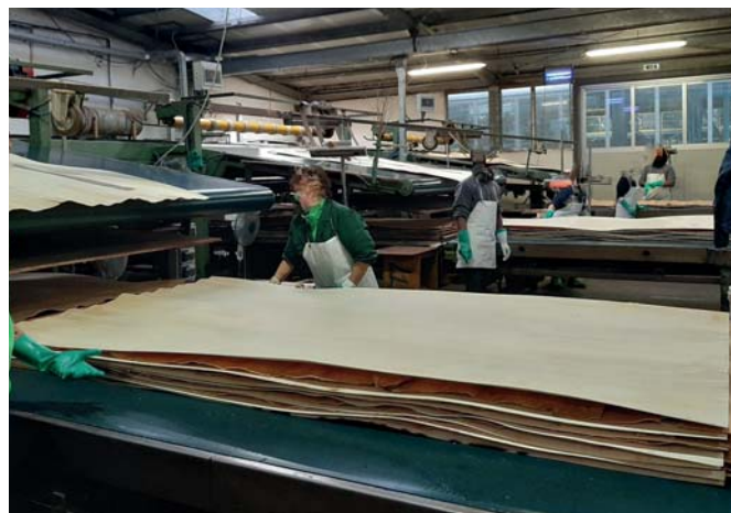
[Fig. II.27] Composizione del pannello in seguito alla stesura dei collanti.
