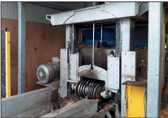
[Fig. II.21] Uscita tronchi dalla macchina per la scortecciatura.
