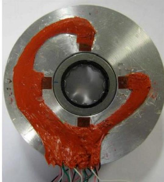
Figura 1.12<sup>[15]</sup>: disposizione radiale di estensimetri
