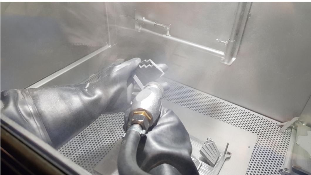
**Figura 3.7** Fase di pallinatura del blocco di polvere all'interno del PRS
