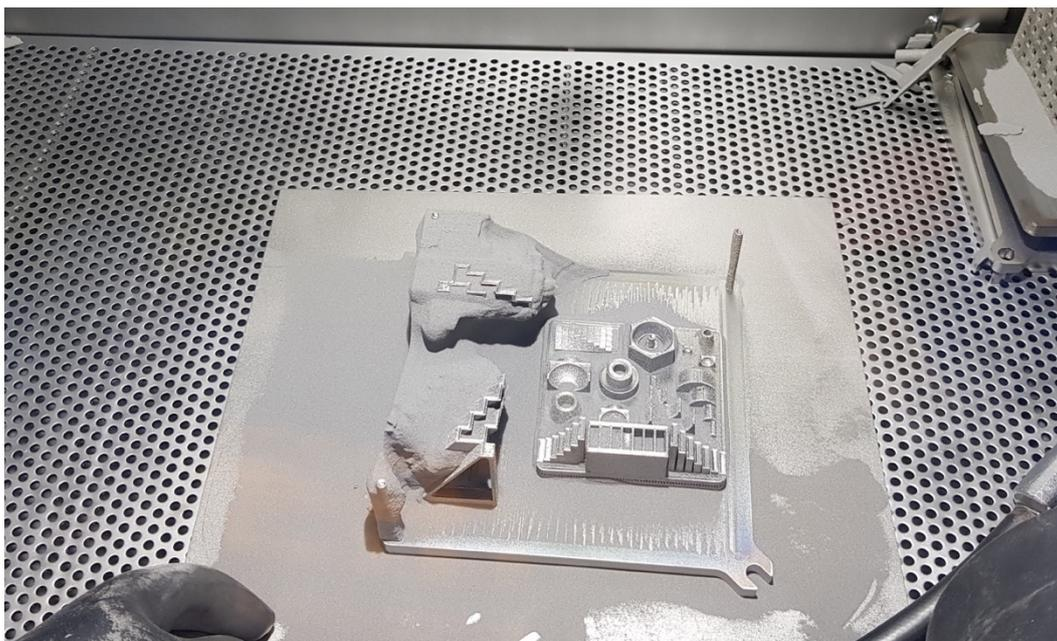
**Figura 3.8** Blocco di polvere in fase di disfacimento all'interno del PRS
