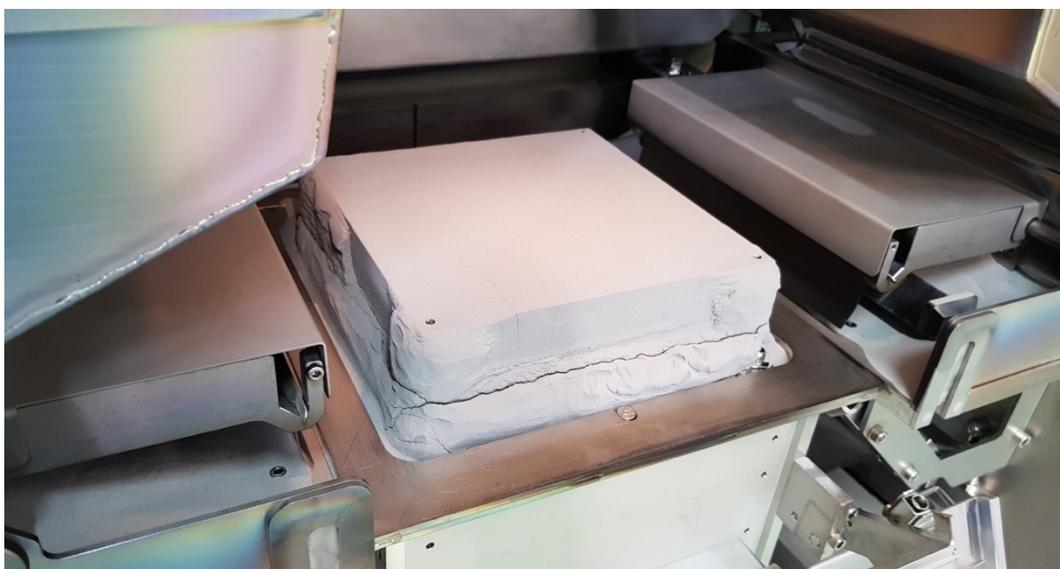
**Figura 3.5** Blocco di polvere sinterizzata sollevato al termine del processo di stampa
