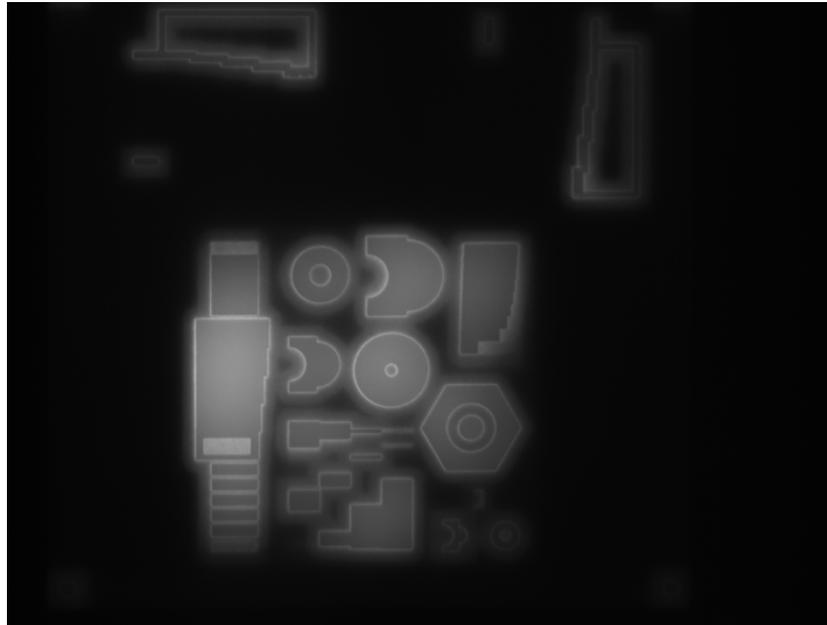
**Figura 3.4** Fotografia scattata dalla LayerQam<sup>®</sup> durante il processo di stampa, in particolare all'altezza di 13,25 mm
