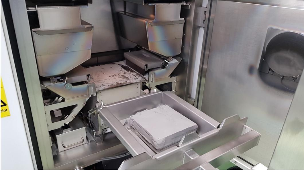
**Figura 3.6** Posizionamento della piastra di costruzione su cui vi è il blocco di polvere sinterizzata sul piatto del carrello
