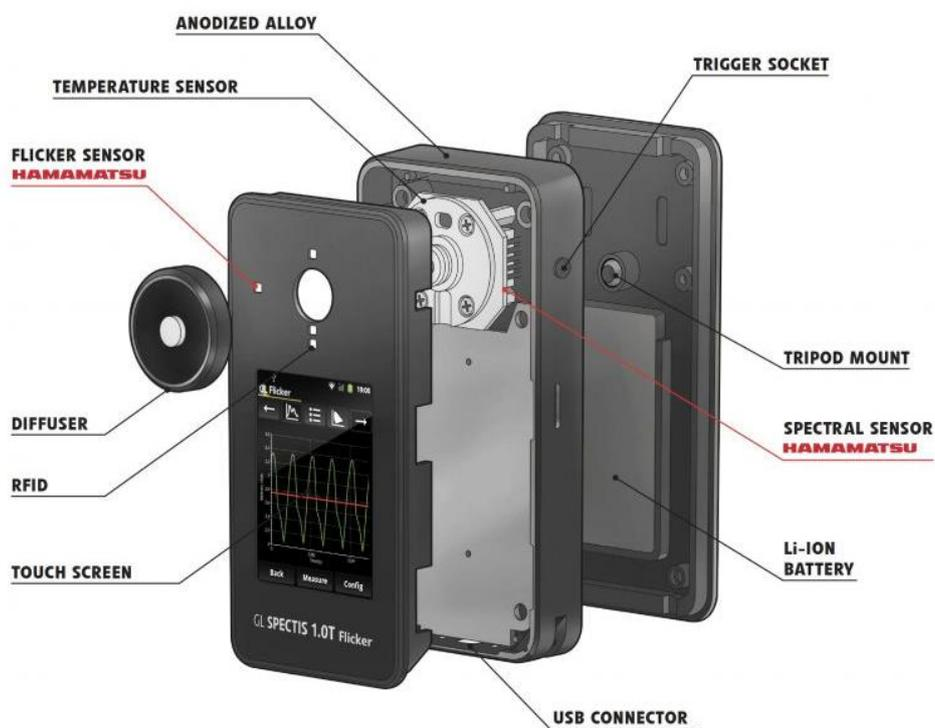
Fig. 45 Componenti dello spettrofotometro utilizzato GL OPTIS 1.0 touch FL.
