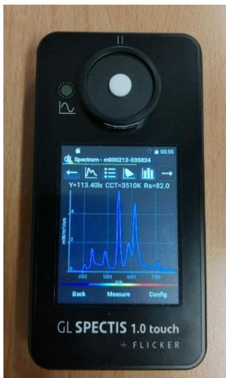
Fig. 44 Foto dello spettrofotometro acceso.
