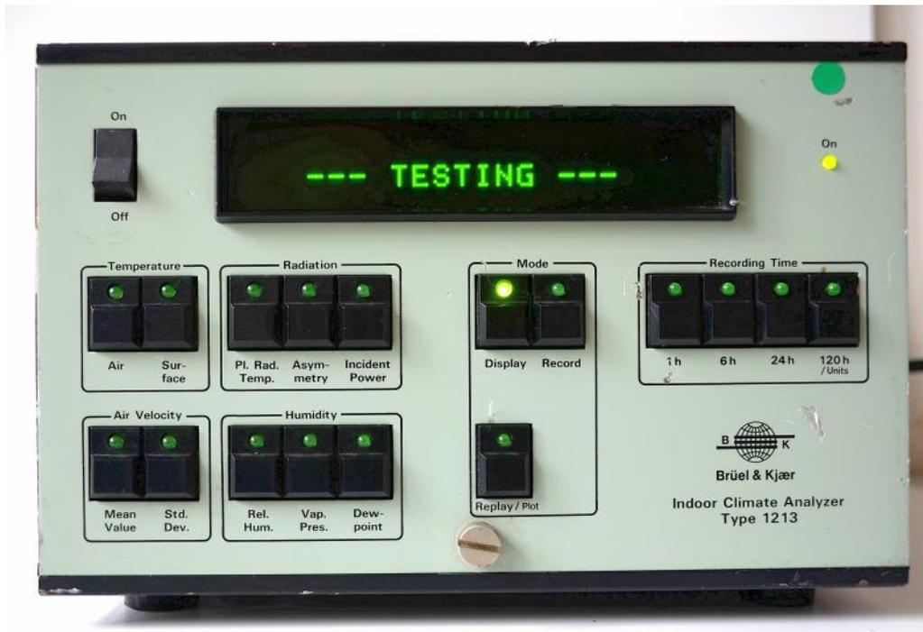
Fig. 36 Microprocessore analizzatore climatico.
