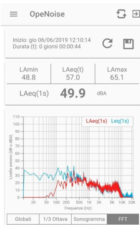
Fig. 52 Esempio di grafico “FFT” da OpeNoise.
