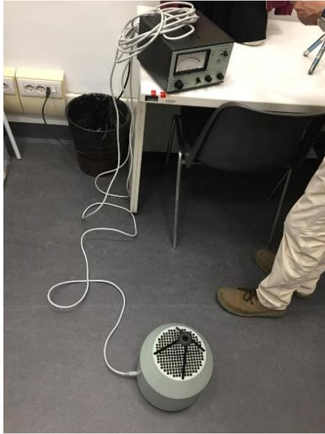
*Fig. 47 Dettaglio della sorgente sonora del fonometro.*
