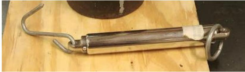
Figure 6.2: Dynamometer
