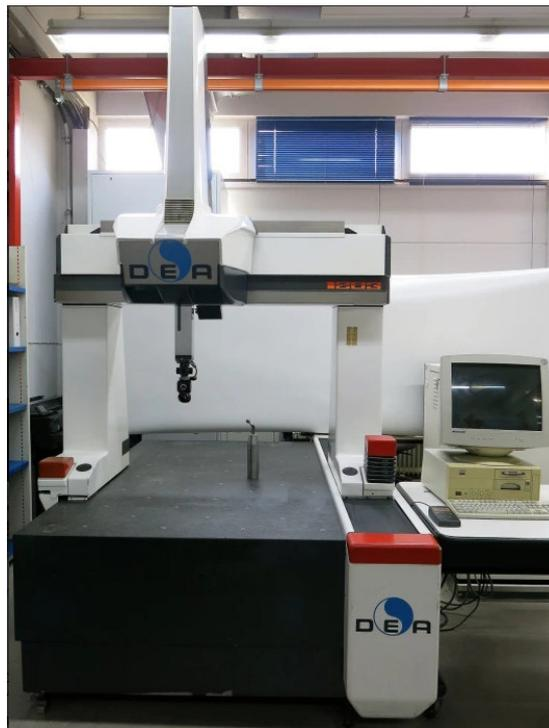
*Figura 5 - Macchina di misura a coordinate, DEA GLOBAL Image 07.07.07.*
