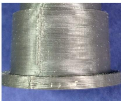
*Figura 17 - Particolare dei difetti dovuti ai punti di attacco dell'estrusione*
