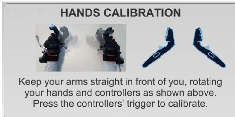
Figura 6.5: Pannello di calibrazione dell'orientamento dei Manus VR
