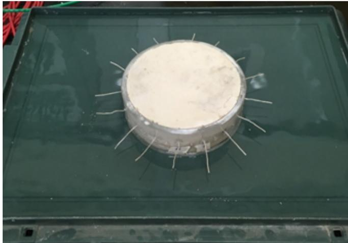
**Figura 5.24:** Campione  $D = 11$  cm sottoposto ad imbibizione (60gg)
