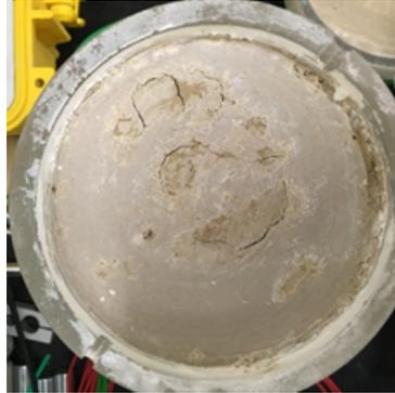
**Figura 5.32:** Fessurazione superficiale del campione colonnare  $H = 30$  cm
