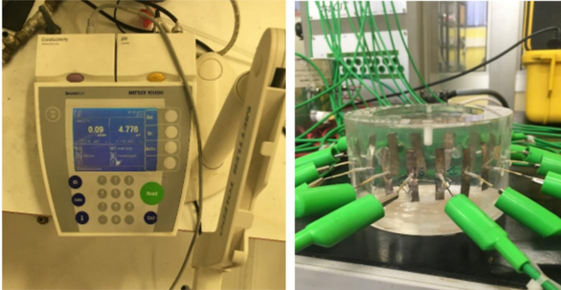
**Figura 4.15:** Conduttimetro e prova ERT su soluzione salina cella  $D = 8$  cm
