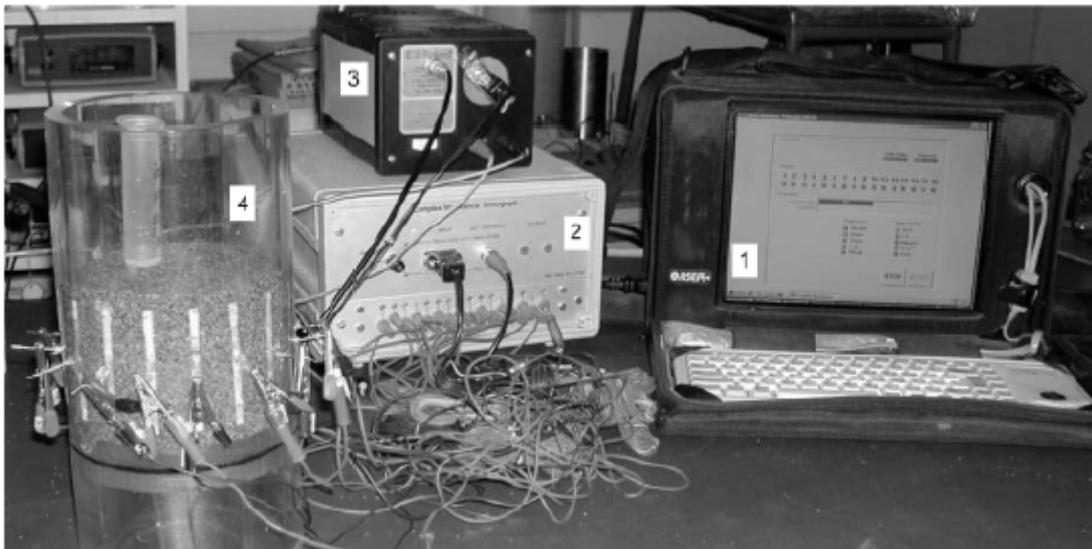
**Figura 2.1:** Attrezzatura di laboratorio per l'esecuzione di tomografie elettriche [Borsic et al., 2005]
