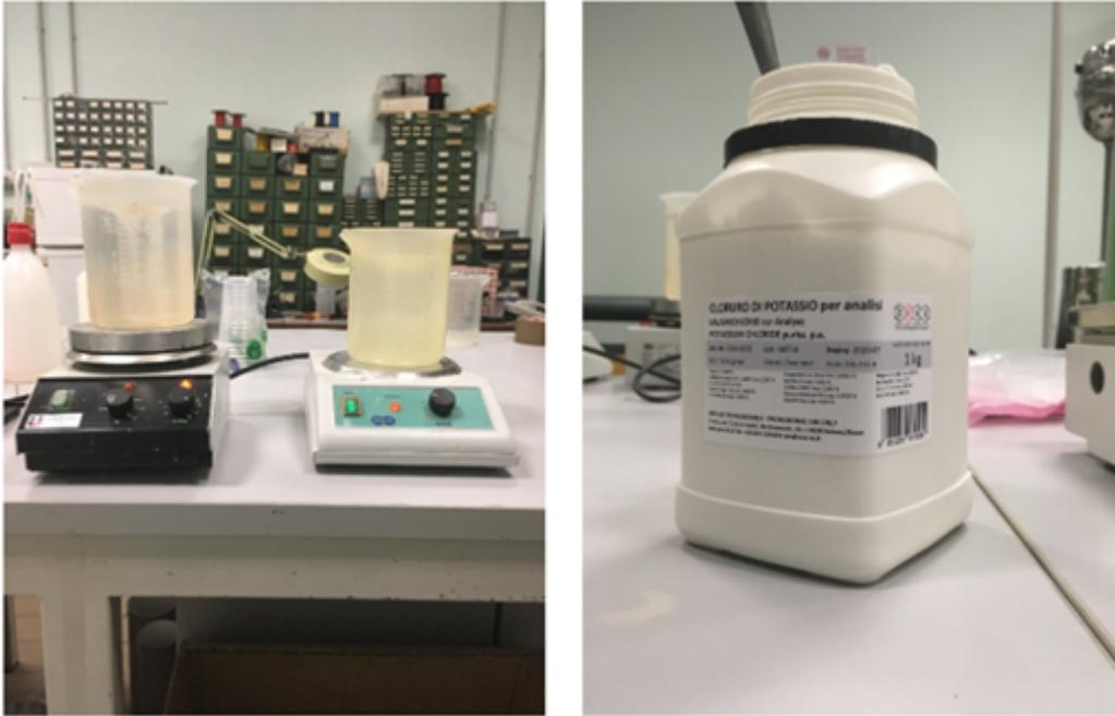
**Figura 4.14:** Preparazione soluzione saline ( $KCl$ )
