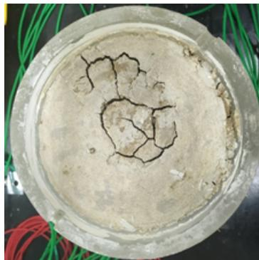
**Figura 5.33:** Stato fisico del campione colonnare al termine del processo di essiccamento
