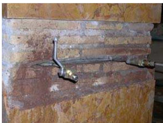
*Figura 3.8: Prova con martinetto piatto singolo eseguita in situ*
