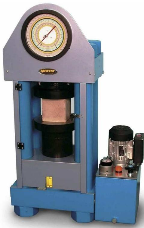
*Figura 3.4: Prova di compressione semplice eseguita con pressa idraulica*
