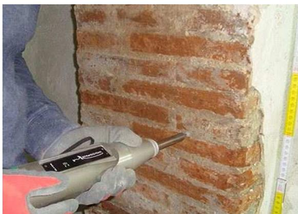
Figura 3.6: Prova penetrometrica eseguita in situ
