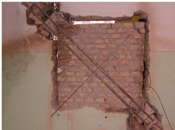
Figura 3.5: Esempio di prova di compressione diagonale eseguita in situ
