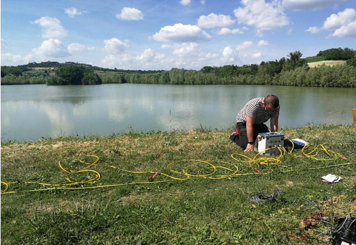
*Figura 2.2.2.9. Prova Geoelettrica sul coronamento della diga di Arignano*
