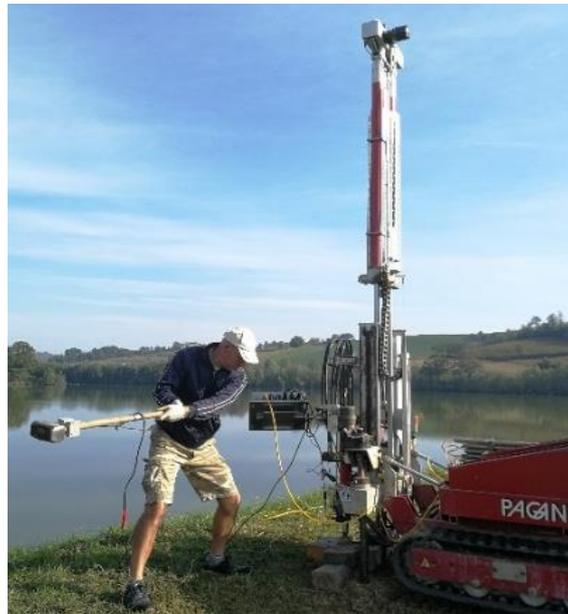
*Figura 2.2.1.2. Misurazione della velocità delle onde di taglio*
