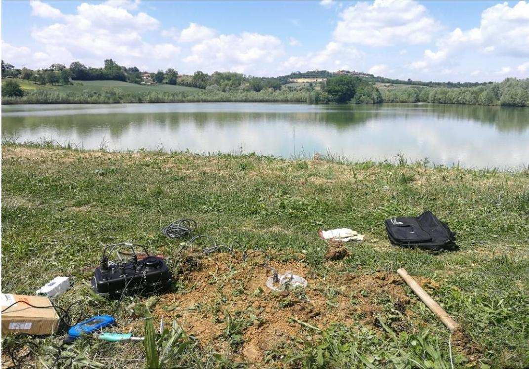
*Figura 2.2.2.5. Prova H/V sul coronamento della diga di Arignano*
