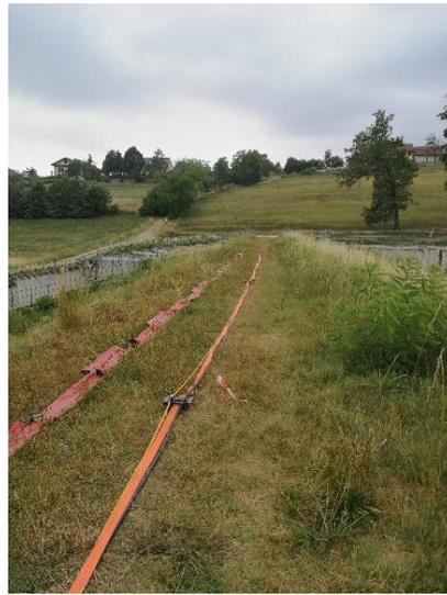
*Figura 2.2.2.14. Sorgente impulsiva con attrezzatura e geofoni ed elettrodi paralleli*
