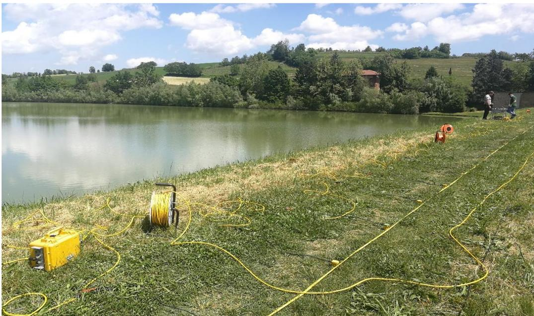
*Figura 2.2.2.1. Prova MASW sul coronamento della diga di Arignano*
