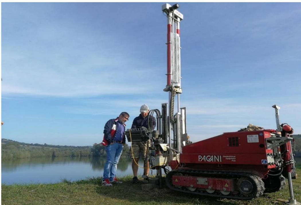
Figura 2.2.1.1. Prove CPTU con cono sismico e dilatometriche sul coronamento della diga
