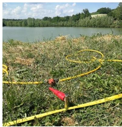
*Figura 2.2.2.10-11. Elettrodi conduttivi ed elettrodi ricevitori*
