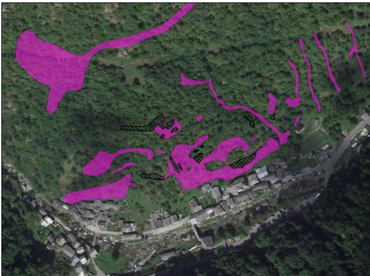
*Figura 6.3-1: Zone di distacco da roccia esposta e da roccia intensamente fratturata*
