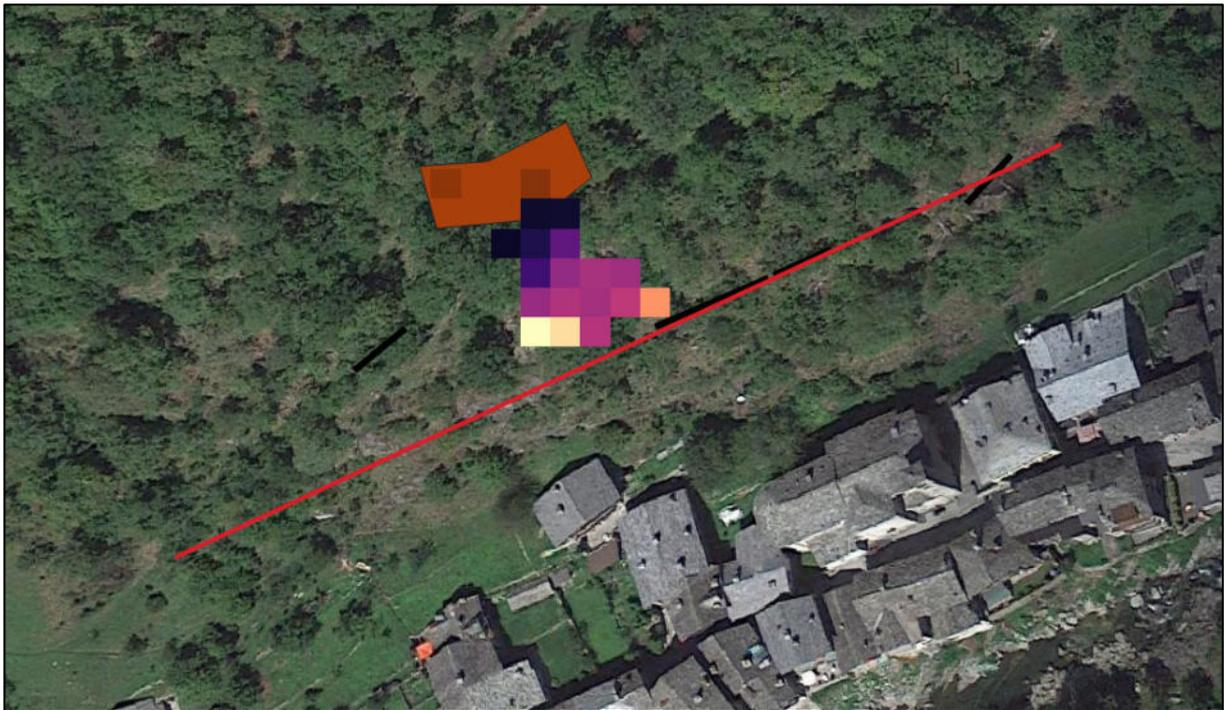
Figura 5.5-1: Inserimento della barriera continua fittizia trasversalmente al versante
