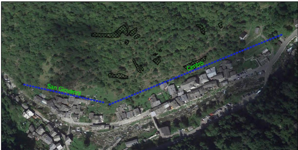
*Figura 6.1-1: Nicchie di distacco da roccia intensamente fratturata*
