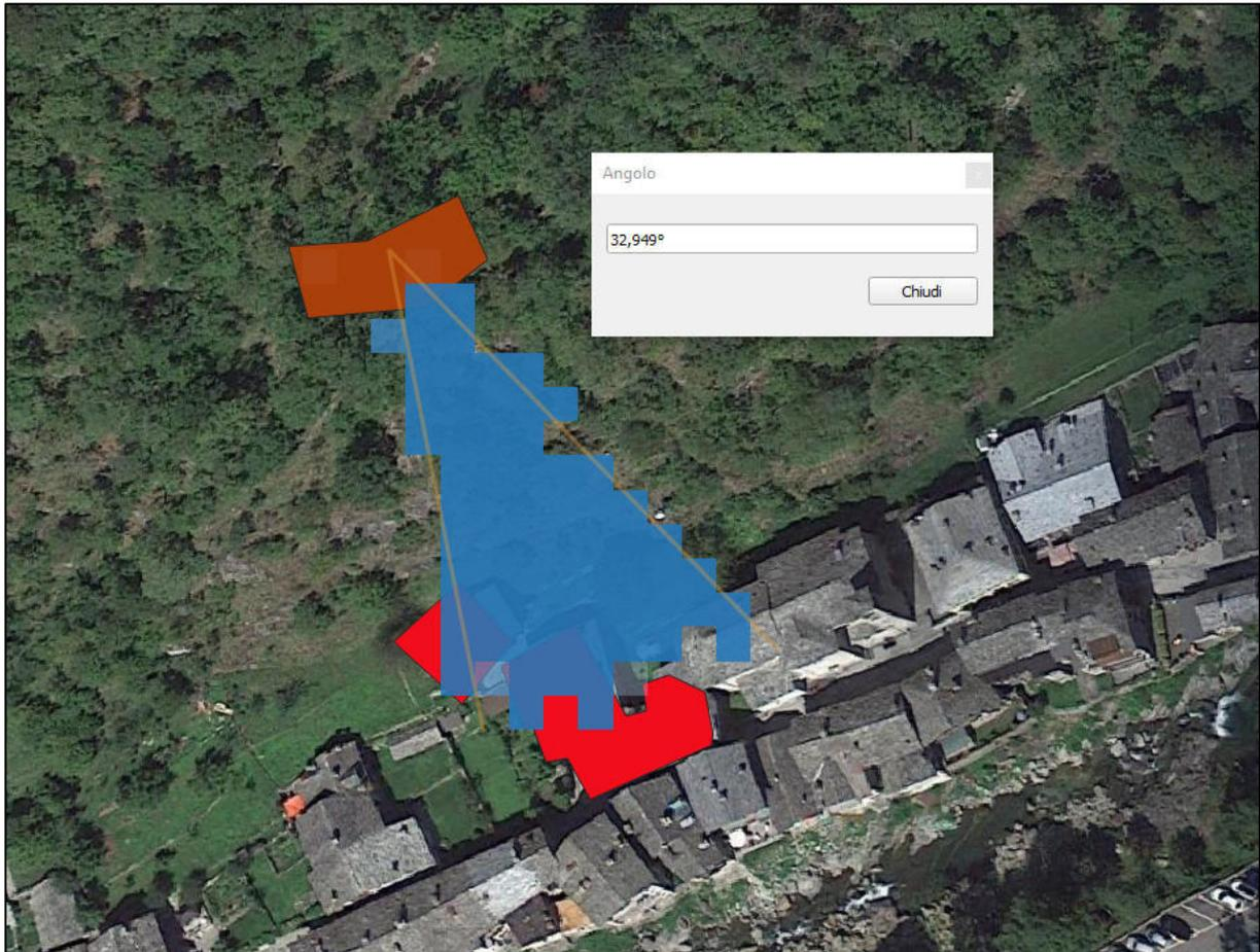
*Figura 5.4-7: Misura dell'angolo di dispersione laterale 2 $\alpha$*
