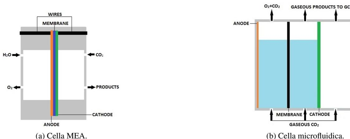
Figura 0.13: Rappresentazione schematica delle celle in fase gas.
