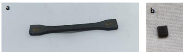
**Figura 3.7.** Provino ad osso di cane (a) e provino a geometria cubica (b)
