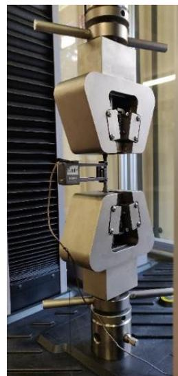
Figura 3.11 Ingrandimento del provino, degli afferraggi e dell'estensimetro
