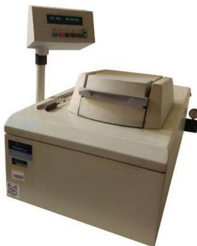
**Figura 3.3** Strumentazione DSC, Paris 1 della Perkin Elmer
