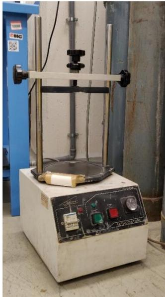
Figura 3.16 Piastra vibrante per prove di Tap density
