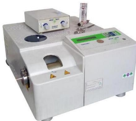
**Figura 3.4** Strumento *TGA/SDTA85* dell'azienda *Mettler Toledo*
