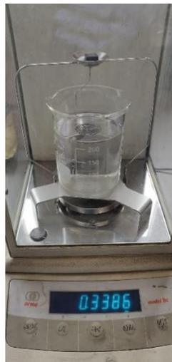
**Figura 3.18** Bilancia di Archimede per misure di densità dei campioni
