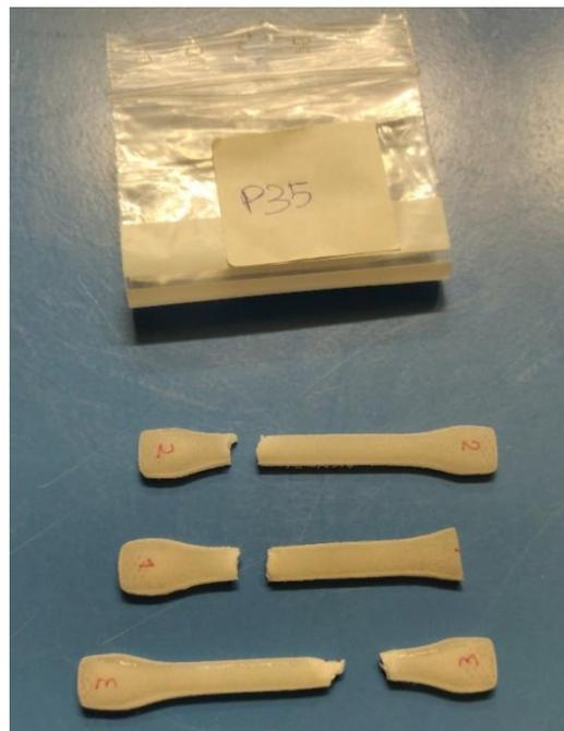
**Fig. 4.33 (c)** Provini di trazione in PP prodotti con densità di energia (P35)
