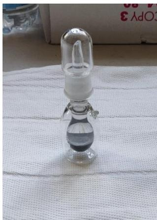
**Figura 3.17** Picnometro per misure di densità delle polveri
