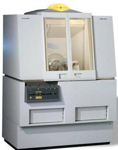
**Figura 3.5** Diffrattometro a raggi X *Panalytical X’PERT PRO PW3040/60*
