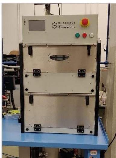
**Figura 3.6** Macchina SLS “SnowWhite” dell’azienda Sharebot
