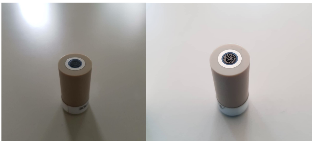
Figura II: Corretta (a sinistra) ed errata (a destra) deposizione dell'inchiostro sull'elettrodo in GC/Pt.
