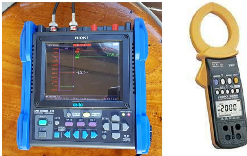
Figura 19 - : Registratore digitale Hioki MR 8880 e pinza amperometrica Hioki 3285
