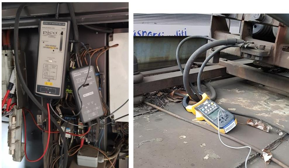
Figura 20 - Sonde di tensione Hioki 9322 e pico Technology TA044 e posizionamento della pinza amperometrica a valle del pantografo
