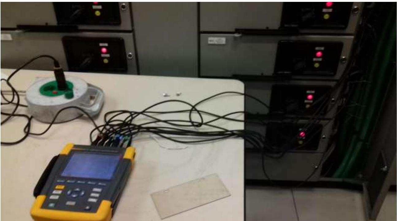
**Figura 109** Analizzatore di rete e del consumo energetico Fluke 435 serie II installato nel PEF di Porta Nuova
