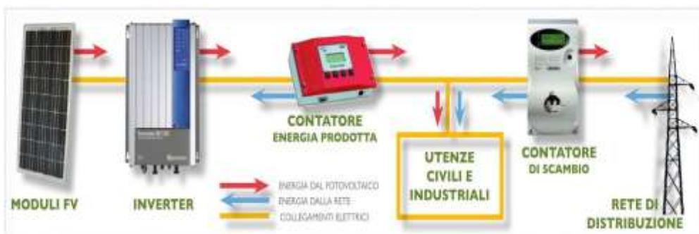
Figura 136 Percorso della corrente elettrica fotovoltaica
