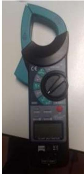
**Figura 123** Pinza amperometrica utilizzata per le misure spot –Le Officine Elettriche 25353
