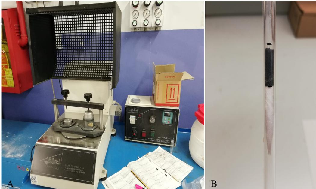
**Figura 2.11** Mulino a sfere (Giuliani Tecnologie s.r.l.) (A); Letto catalitico fisso su supporto di lana di quarzo (B)
