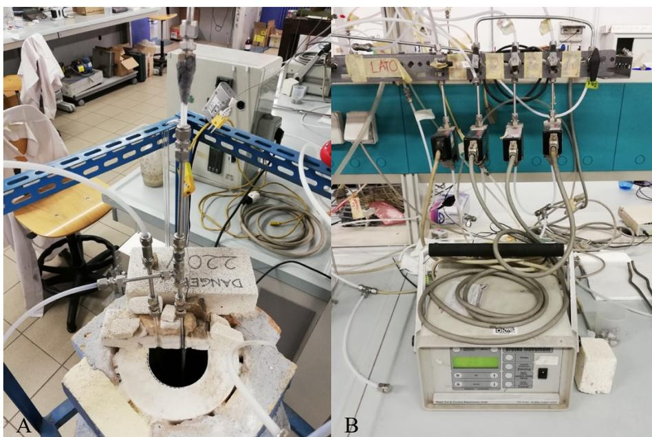
**Figura 2.9** Forno elettrico con controllore PID (A); centralina *mass-flow controller* (B)
