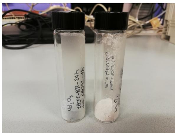
**Figura 2.2** Ossidi non dopati dei due metalli:  $\text{Nd}_2\text{O}_3$  e  $\text{La}_2\text{O}_3$
