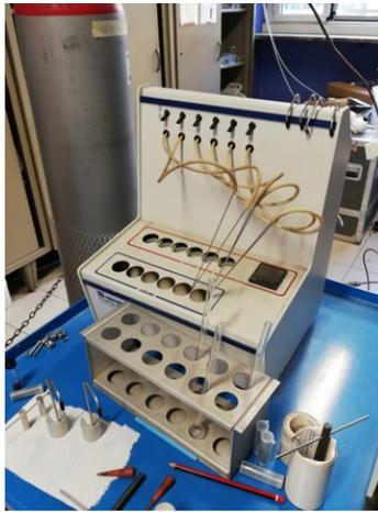
**Figura 2.5** Strumentazione per il pretrattamento della polvere in esame
