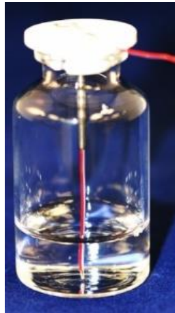
Figura 5. Misura della temperatura del prodotto in singoli flaconcini con una termocoppia e l'uso di un dispositivo per posizionare il sensore al centro del contenitore (figura tratta da Nail, et al., 2017 e riprodotta con modifiche).
