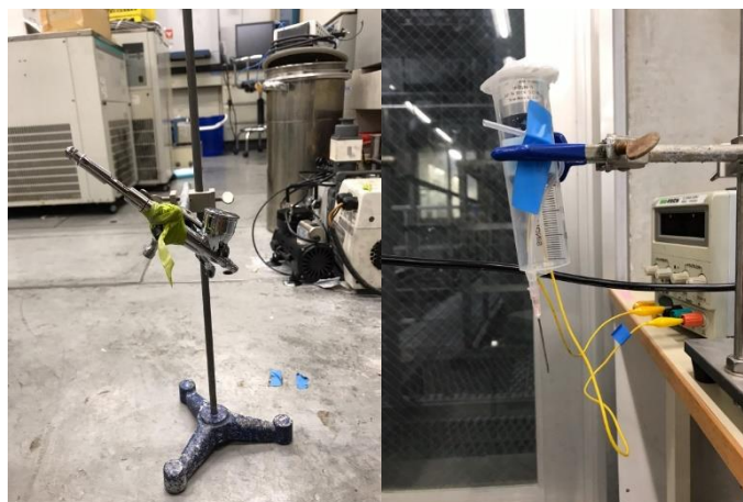
Figura 4: Immagine dei meccanismi usati per atomizzare le soluzioni. Meccanismo 1 sulla sinistra, meccanismo 2 sulla destra.
