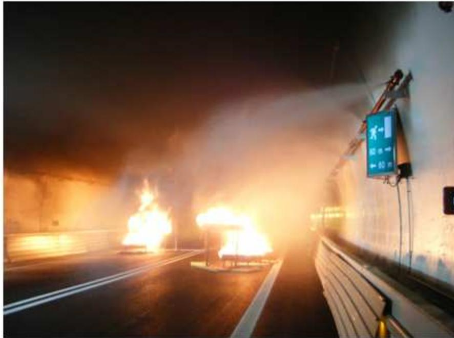
Figura 31: Esempio di impianto di spegnimento a diluvio [68]
