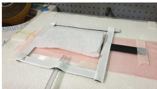
(d) Posizionamento dello strato di assorbente aeratore
