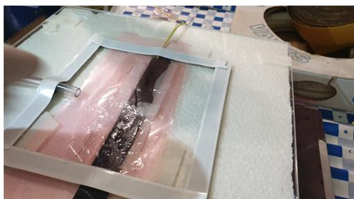
(c) Posizionamento dello strato di microforato
