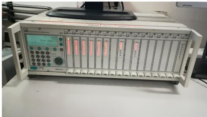
**Figura 4.14:** Centralina di acquisizione estensimetrica.
