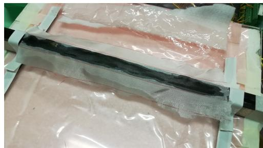
(d) Posizionamento dello strato di tessuto peel-ply
