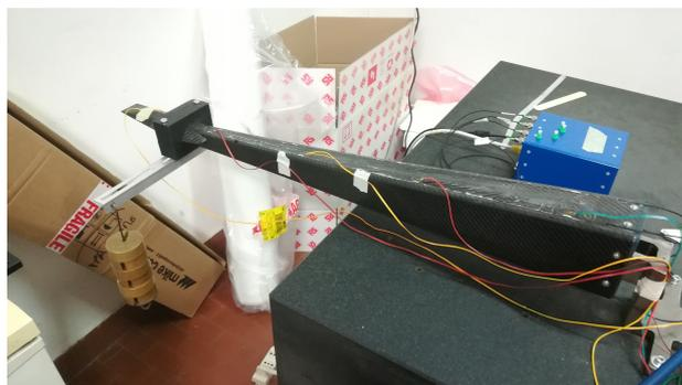
**Figura 6.14:** Applicazione del carico fuori dal piano di simmetria per test flesso-torsionali.
