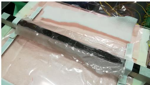
(e) Posizionamento dello strato di microforato
