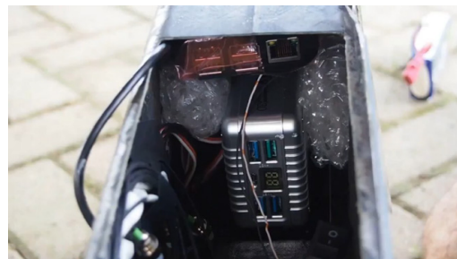
(d) Raspberry e powerbank nella parte anteriore della fusoliera
