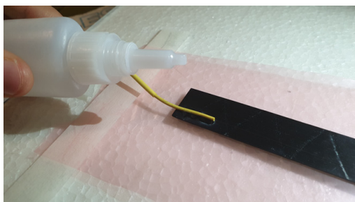
(a) Incollaggio della fibra sul provino
