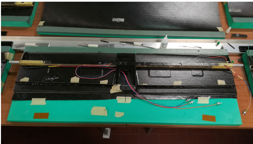
Figura 5.22: Disposizione componenti interni pre chiusura stampi.
