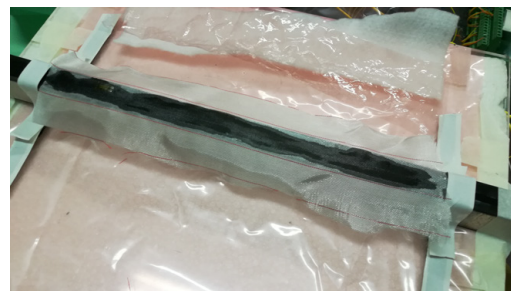
(d) Posizionamento dello strato di tessuto peel-ply
