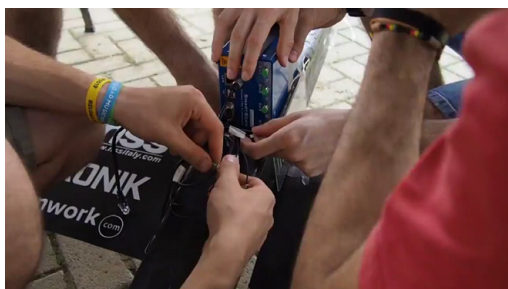
(e) Posizionamento interrogatore e collegamento fibre.
