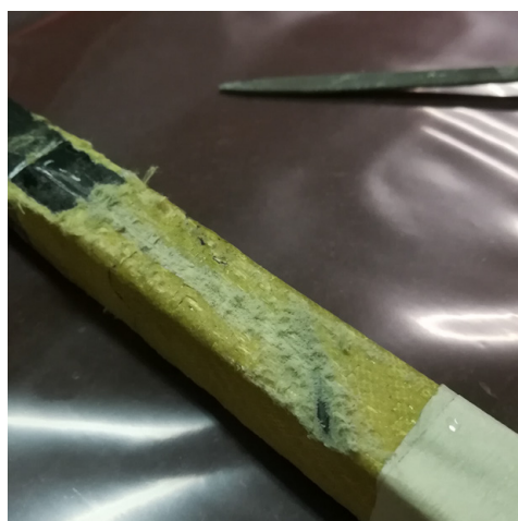
(a) Sede pre incollaggio
