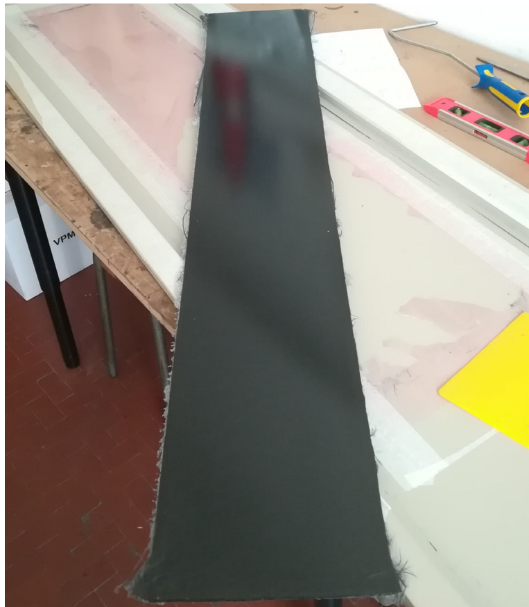
Figura 5.5: Laminato in fibra di carbonio estratto dal sacco a vuoto.
