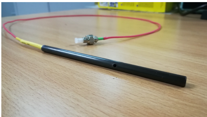
Figura 5.10: Sensore FBG inglobato in tubo capillare per la compensazione termica.
