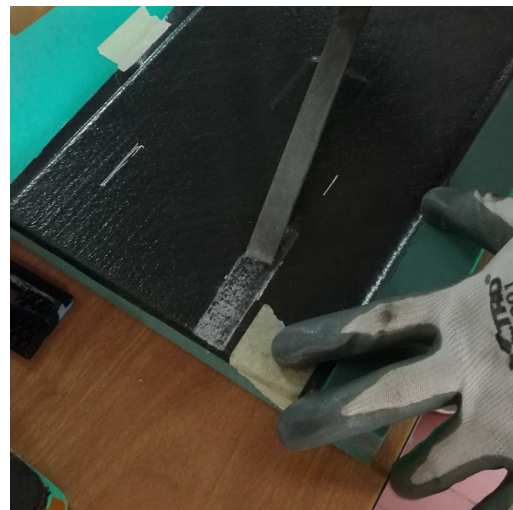
(b) Rimozione strato interno rivestimento.
