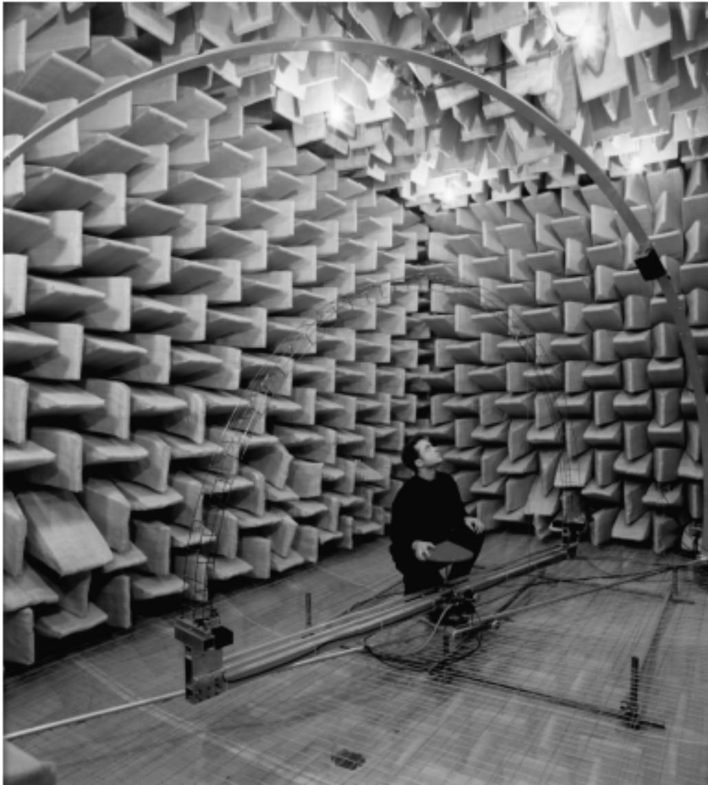
*Figura 32 – La figura mostra il sistema di misura della diffusione emisferica, in camera anecoica. Si vedono: arco esterno dove è posta la sorgente, un arco interno trasparente dove sono posti i microfoni, ed al centro il diffusore [22].*
