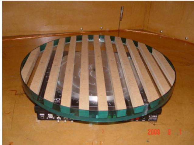
Figura 53 – Copertura perimetro piatto rotante con materiale acrilico in camera riverberante in scala [46].
