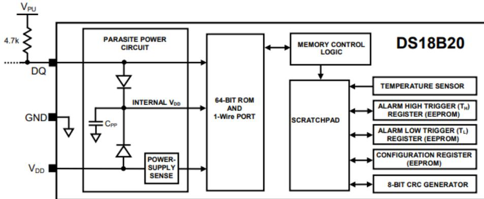
Figure 2.11. DS18B20 block diagram
