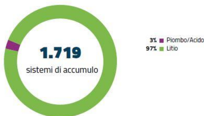
Figura 15. Sistemi di accumulo al servizio di impianti fotovoltaici incentivati. Fonte: GSE
