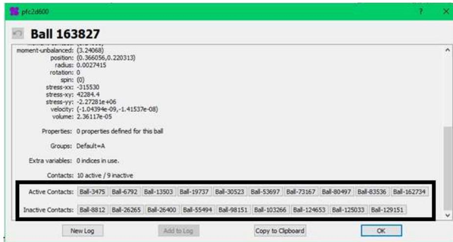
Figura 29. Finestra restituita da PFC<sup>2D</sup> contenente tutte le informazioni relative ad una certa particella.
