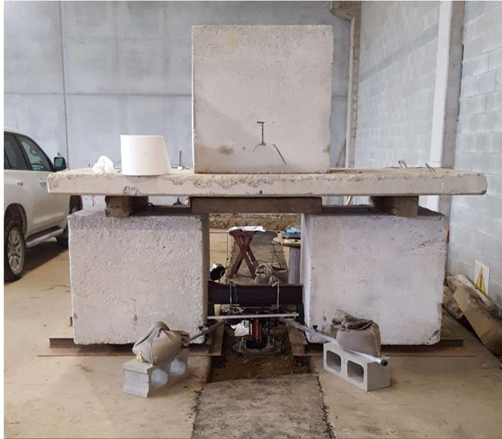
Figura 3. Sistema di applicazione del carico
