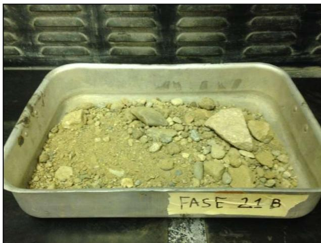
Figura 21: Composizione del Materiale di Rinterro B
