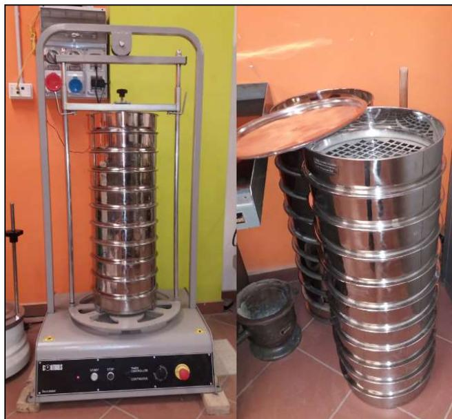
Figura 15: Separatore meccanico e pila di setacci per la vagliatura degli aggregati
