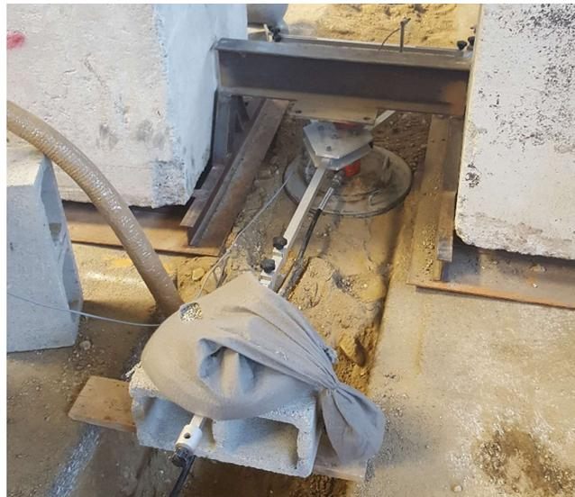
*Figura 12. Sistema di applicazione del carico*
