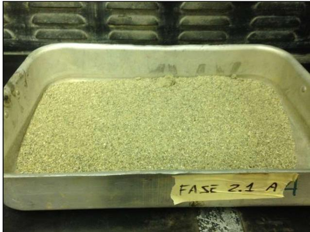
Figura 18: "Campione 1-A sottoposto ad analisi granulometrica"
