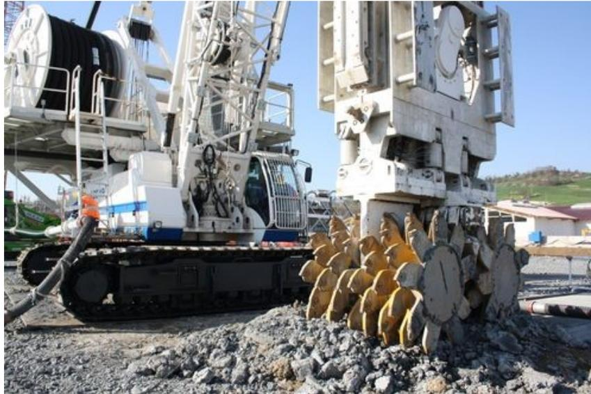
*Figura 37 Impiego di un'idrofresa per la realizzazione di uno scavo*
