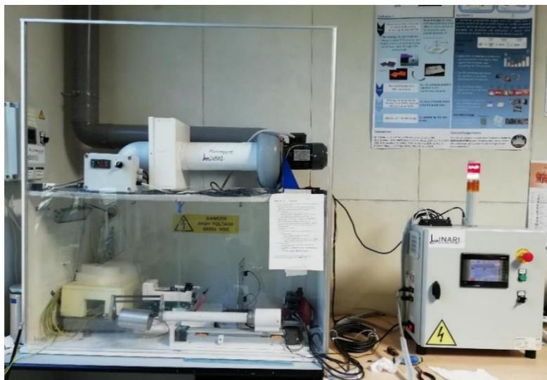
**Figura 2.14** Sistema di electrospinning in conformazione orizzontale, utilizzato in questo lavoro di tesi.
