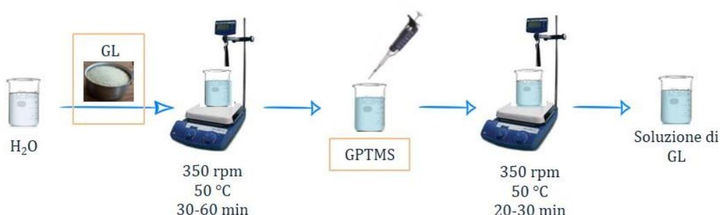
**Figura 2.10** Schematizzazione del protocollo di preparazione della soluzione di gelatina (GL).
