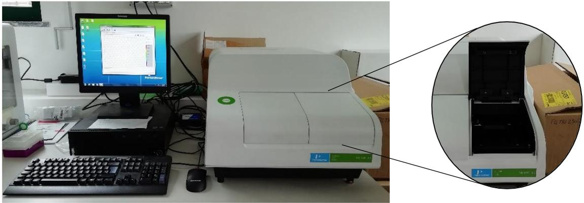
**Figura 2.25** *Dispositivo Multimode plate reader VICTOR X3 della Perkin Elmer, con particolare della zona di posizionamento della piastra nell'ovale a destra.*
