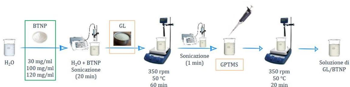
**Figura 2.11** Schematizzazione del protocollo di preparazione della dispersione delle nanoparticelle di titanato di bario (BTNP) in gelatina (GL).
