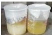
**Figura 4.2: Foto relativa al campione in parte neutralizzato con NaOH (2M) a sx e NON neutralizzato a dx.**
