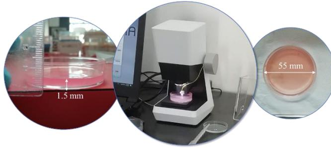
**Figura 4.14: Dimensioni campione e posizionamento per il test meccanico.**
