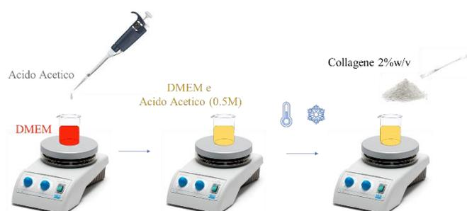
**Figura 3.3A: Primo step relativo alla preparazione della soluzione a base di collagene.**
