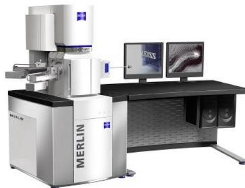
**Figura 3.16: FE-SEM a disposizione presso il DIMEAS.**
