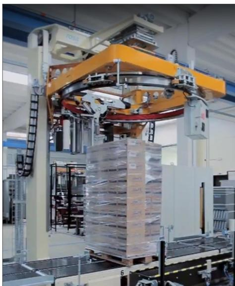
Figura 11 - Macchina avvolgitrice ad anello rotante, Tosa modello 126 (fonte: <https://www.tosagroup.com/>).
