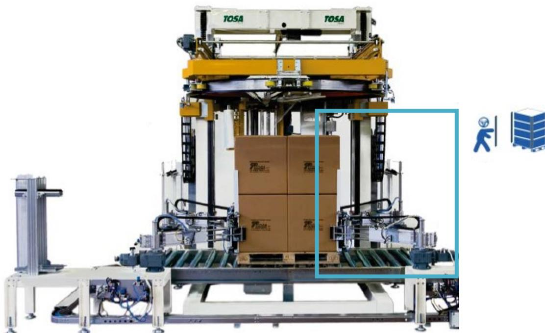
Figura 35 - Macchina avvolgitrice ad anello rotante con, riquadrato in azzurro, l'accessorio predisposto all'applicazione dei dispositivi metti angolari
