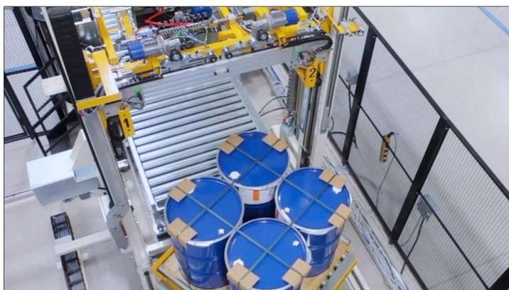
Figura 10 Reggiatrice CMR modello per reggiatura verticale con testata superiore (fonte: <https://www.tosagroup.com/>).
