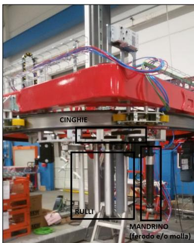
Figura 41 - Gruppo prestiro modello Tosa 492 installato su una macchina avvolgitrice ad anello rotante con, riquadrati, i componenti che richiedono un maggior tempo per la sostituzione presso il cliente
