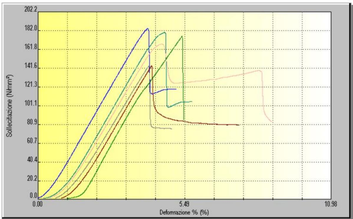
Figura 4.16 - Risultati prove compressione di provini rinforzati con fibre di carbonio.
