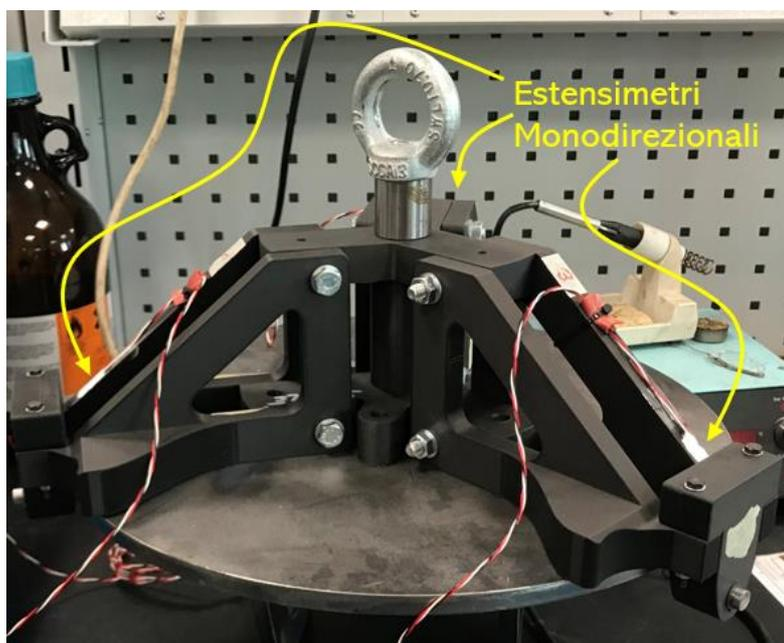
*Figura 5.4 - Lifting Tool equipaggiato con tre estensimetri.*
