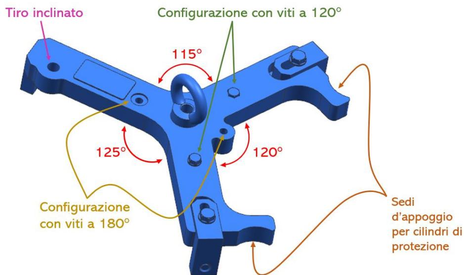
Figura 3.2 - Lifting Tool ora in utilizzo.
