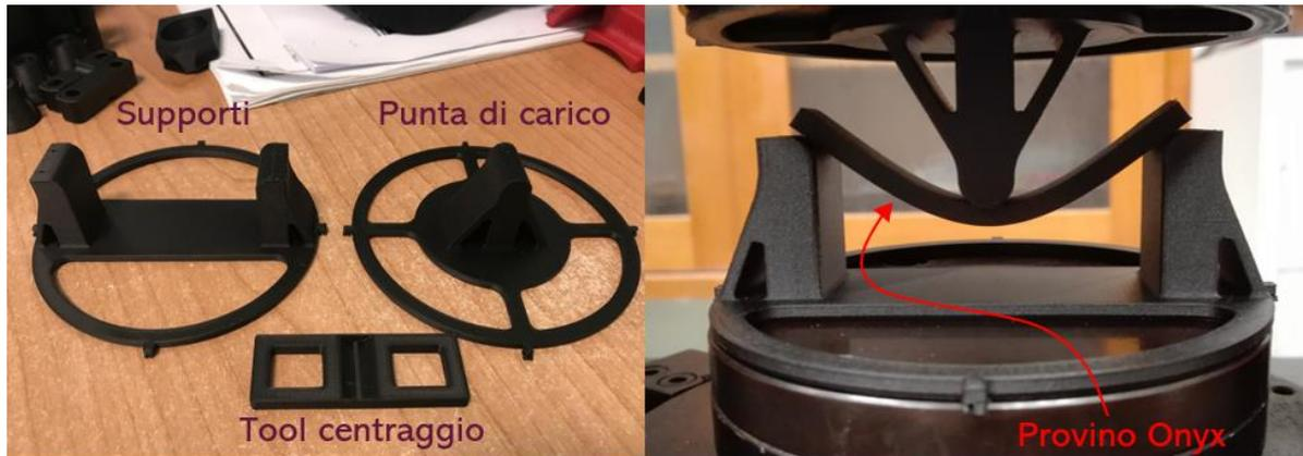
Figura 4.8 - Tool utilizzato per test di flessione stampato in Onyx®.
