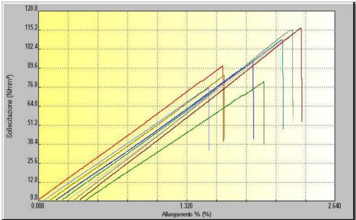
Figura 4.12 - Risultati prove trazione di provini rinforzati con un solo layer di fibre.
