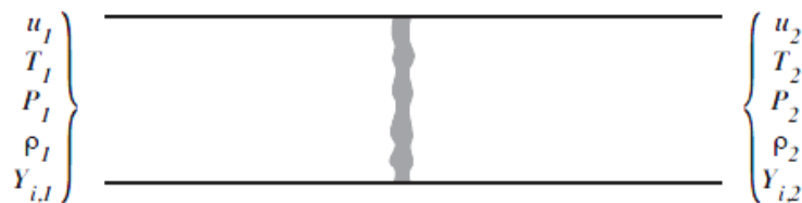
Figura 1.4: Rappresentazione schematica di un tubo adiabatico ed impermeabile, in grigio è indicato il fronte di fiamma [2]
