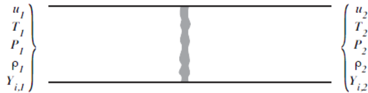
Figura 2.1: Caso pratico cui ci si vuole ricondurre per la determinazione della velocità laminare [2]
