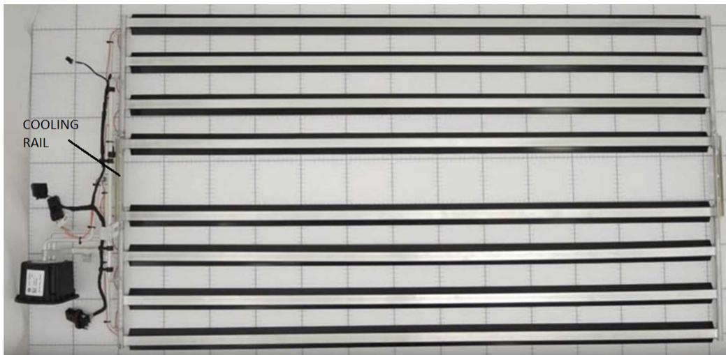
Figura 2.52: Cooling system presente nel pacco batteria della *BMW i3*[31].
