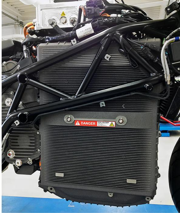
Figura 2.20: Alloggiamento del pacco batteria nella moto *Energica Ego*[38].
