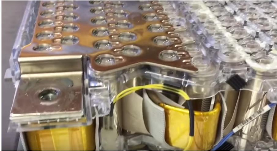
Figura 2.39: Particolare sul connettore principale del modulo *Tesla*[37].
