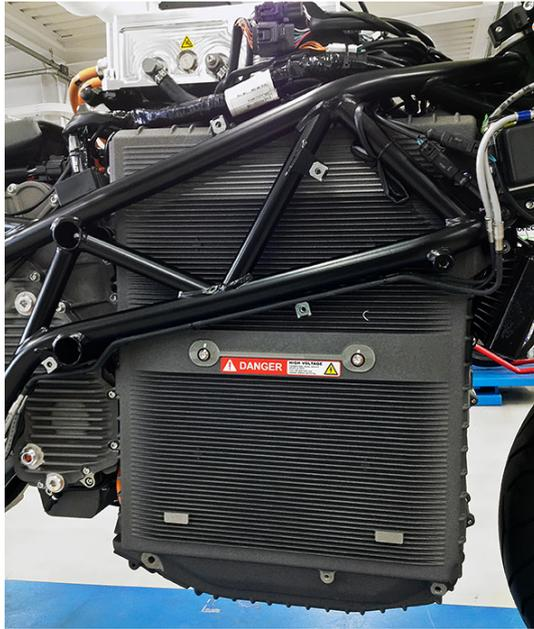
Figura 3.2: Posizione del pacco batteria, *Energica Ego*[38].
