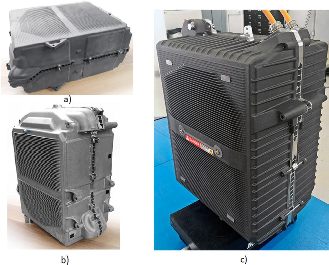
Figura 2.21: Immagini del pacco batteria durante il processo di prototipazione[38]: a) prototipo stampato in 3D con la tecnologia della sinterizzazione laser selettiva; b) pacco batteria realizzato in alluminio con la tecnica della fusione in sabbia; c) componente finito.
