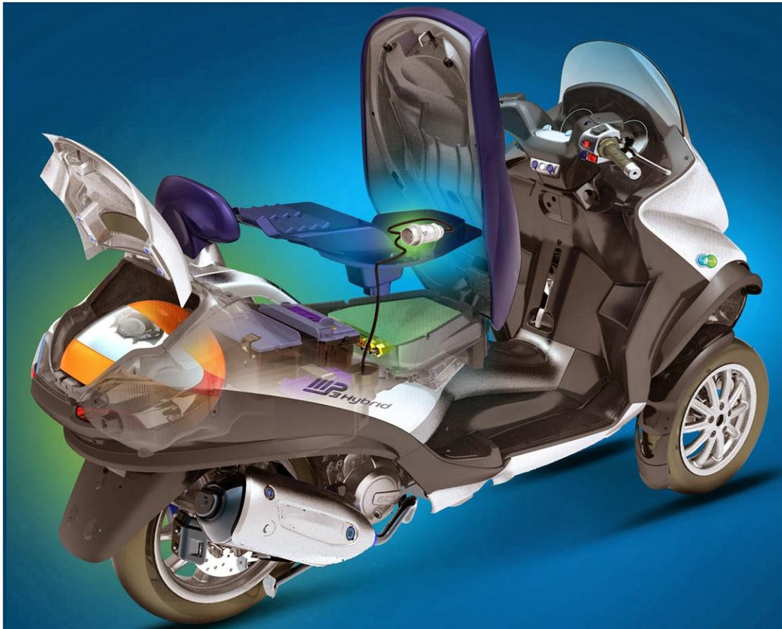
Figura 2.26: Scooter *Piaggio MP3 Hybrid 300ie*, dotato di Plug-In.
