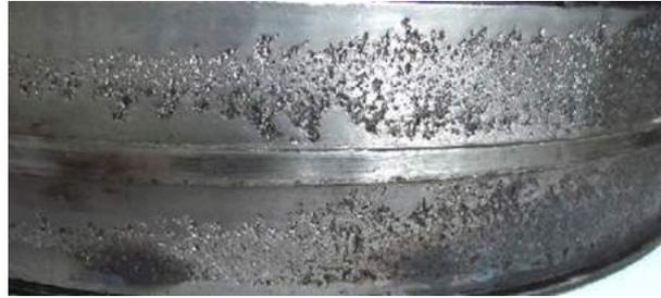
**Figura 3.5:** Effetto del *pitting* sulla ralla interna di un cuscinetto volvente
