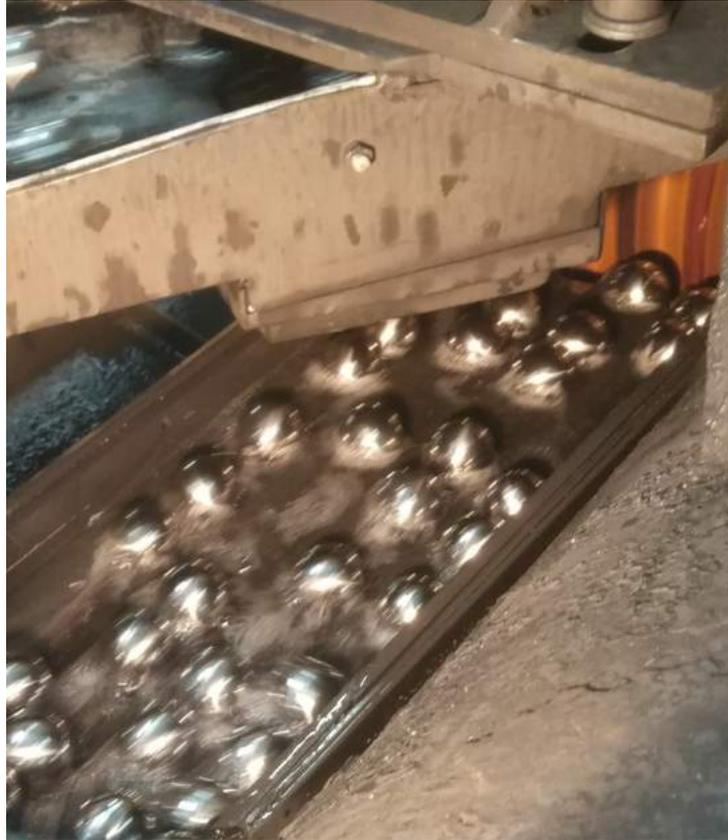
**Figura 2.6:** Particolare del carico/scarico sfere da una lappatrice
