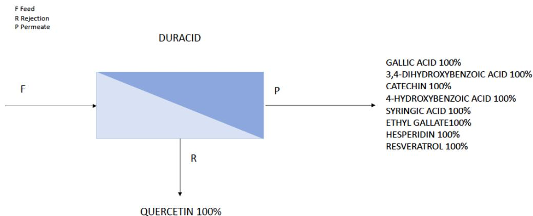
**Figura 11** - Schema DURACID (F, feed: alimentazione, R, rejection: ritenzione, P, permeate: permeato)
