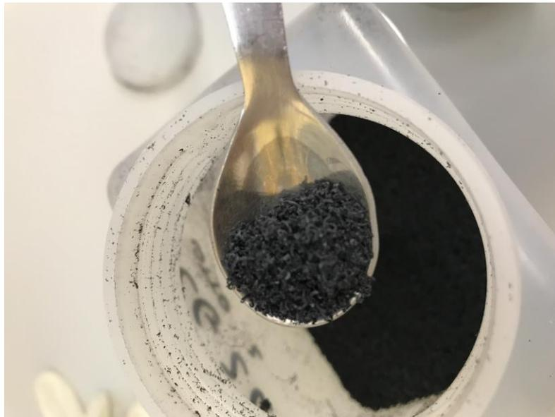
**Figura 3.1:** GNP di partenza, usato per la preparazione dei nanopapers
