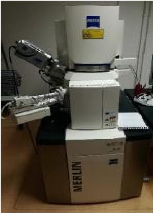
**Figura 5.7:** Il Microscopio elettronico a scansione con sorgente a emissione di campo (FESEM) del Politecnico di Torino
