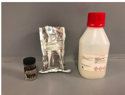
Figura 5.5 Componenti della formulazione liquida, da sinistra BEMA, fotoiniziatore e PEGMA.
