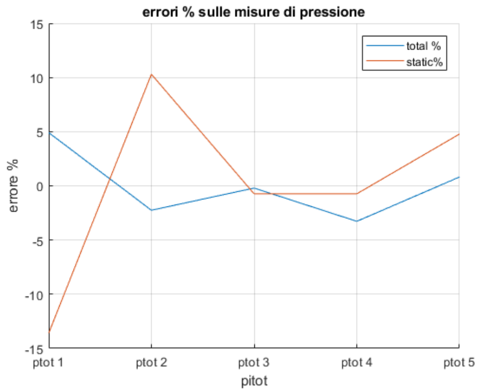
Figura 2-12 errore percentuale di ogni pitot confrontato con la curva del pitot della galleria
