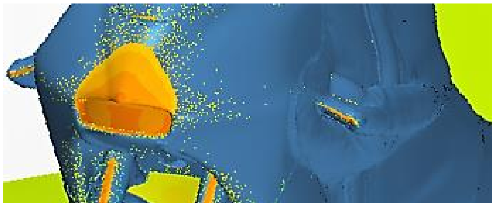
Figura 3-2 superficie esterna allo strato limite (in blu ) dove è possibile notare la grossa struttura vorticoso a valle della mano del pilota
