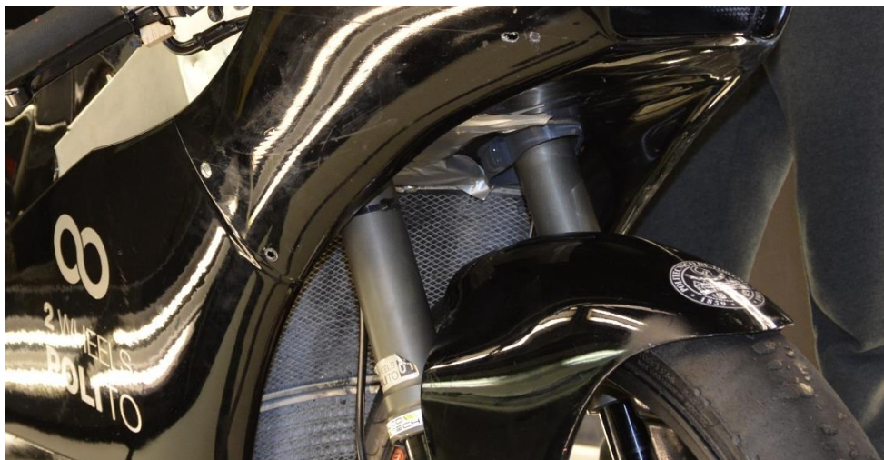
Figura 4-4 dettaglio della chiusura attuata al di sotto delle piastre sterzo, ossia la configurazione migliore della giornata 1
