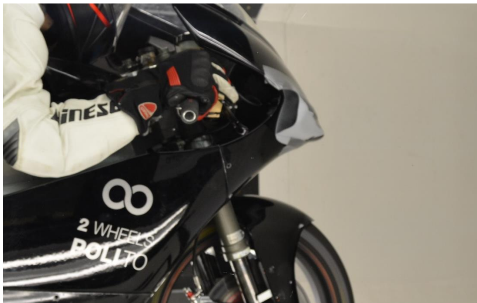
Figura 4-7 Dettaglio del paramano in questione, che modifica sostanzialmente la parte anteriore della carena
