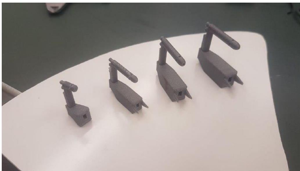
Figura 2-9 alcune delle configurazioni stampate in 3d e testate preliminarmente in galleria
