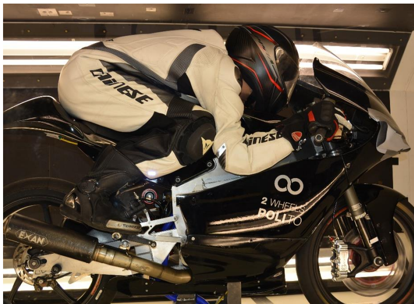
Figura 4-24 Differenza di posizione del pilota dopo e prima della rimozione dell'air-box, cerchiata in rosso nella prima immagine si può notare la differenza tra le posizioni del mento del pilota una volta tolta la copertura nera dell'airbox originale e sostituita con una copertura più bassa in pvc bianco.
