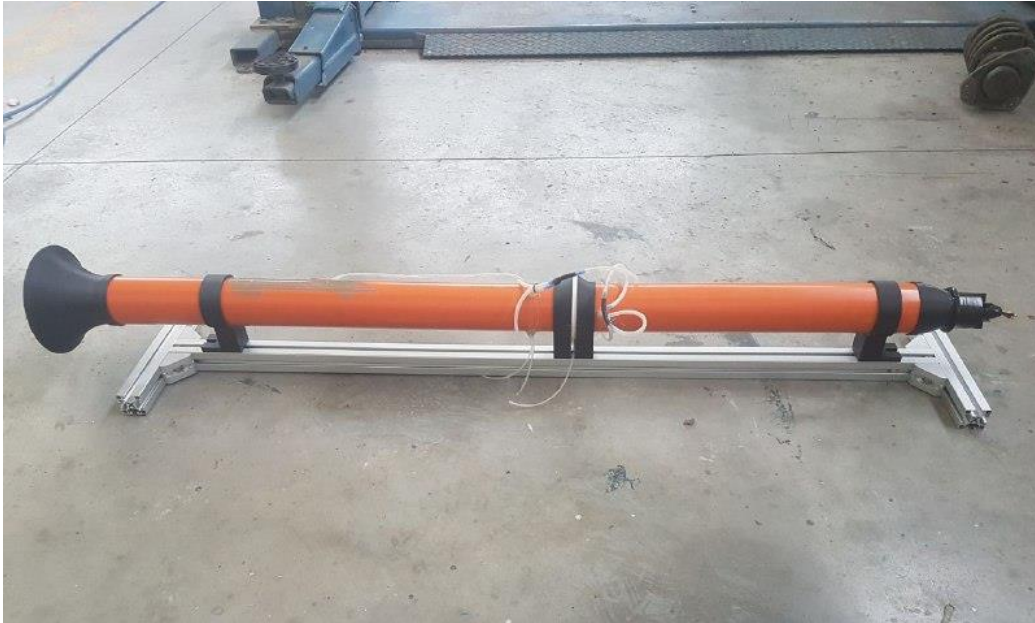
Figura 2-8 galleria auto costruita analoga a quella di laboratorio che utilizza componenti elettronici per aeromodellismo
