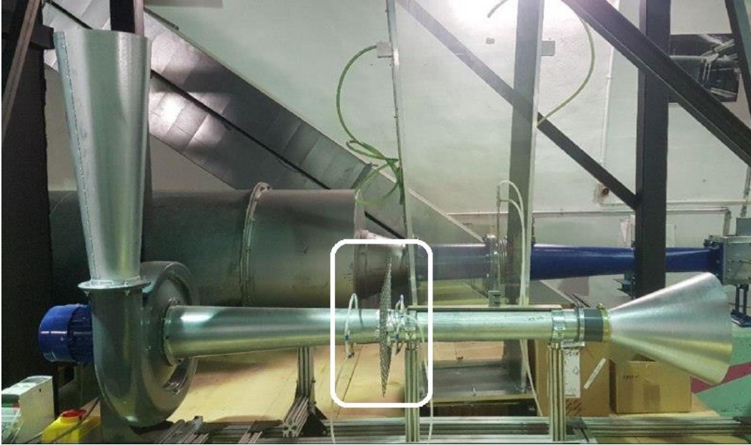
Figura 2-3 galleria del vento per misurazioni di resistenza di mezzi porosi. Cerchiata in bianco la sezione di prova ove viene inserito il mezzo su cui si vuole effettuare la misura, ai lati le prese di pressione statica e a destra le tubazioni connesse al pitot interno per la misura della velocità
