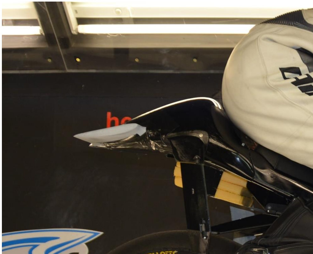
Figura 3-15 fotografia laterale del profilo installato nella parte terminale del codino
