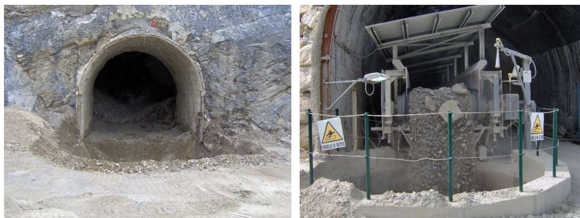
*Figura 21 - A sinistra, tramoggia in roccia che connette il fornello superiore a quello inferiore; a destra, impianto di estrazione e nastro trasportatore per la movimentazione dell'abbattuto dal fornello superiore a quello inferiore.*
