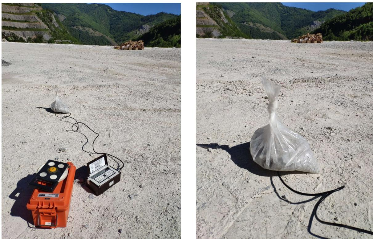
Figura 62 - A sinistra, posizionamento della stazione di monitoraggio Nomis SM; a destra, particolare del geofono posizionato sotto il sacco di sabbia.
