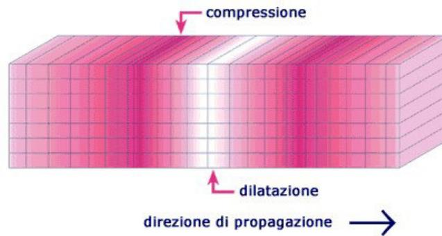
Figura 46 - Rappresentazione dell'onda longitudinale di compressione.
