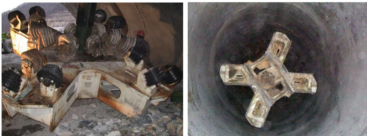
*Figura 20 - Raise borer utilizzato per lo scavo del fornello.*
