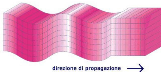
Figura 47 - Rappresentazione dell'onda trasversale di taglio.
