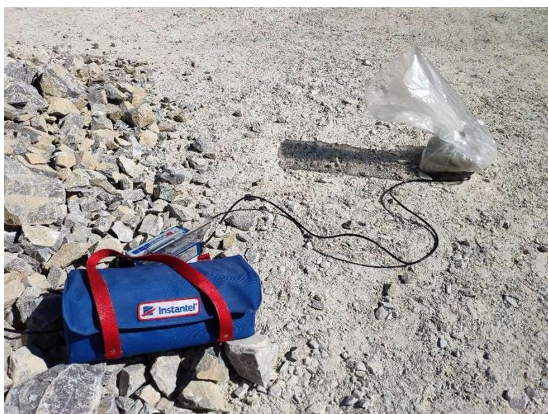
*Figura 61 - Posizionamento del sismografo Instantel MiniMate DS-077.*
