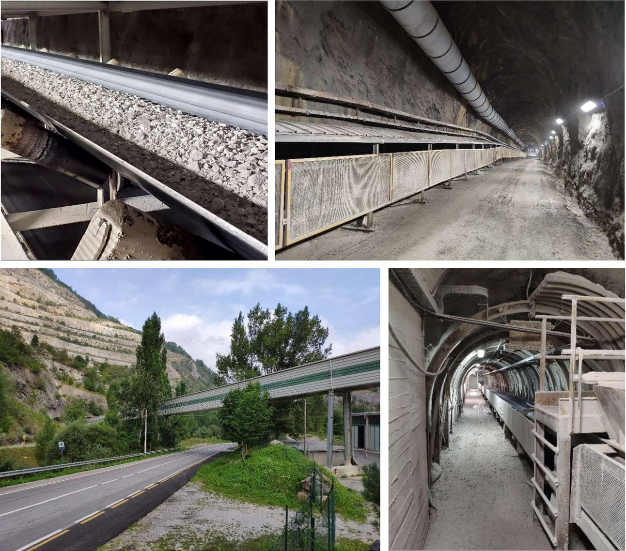
*Figura 33 - Calcare in uscita dal frantoio; nastro trasportatore in uscita dalla galleria di base e in sopraelevata sulla strada provinciale; stazione di partenza del nastro Stereoduc.*
