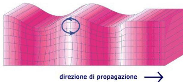
Figura 48 - Rappresentazione dell'onda di Rayleigh.
