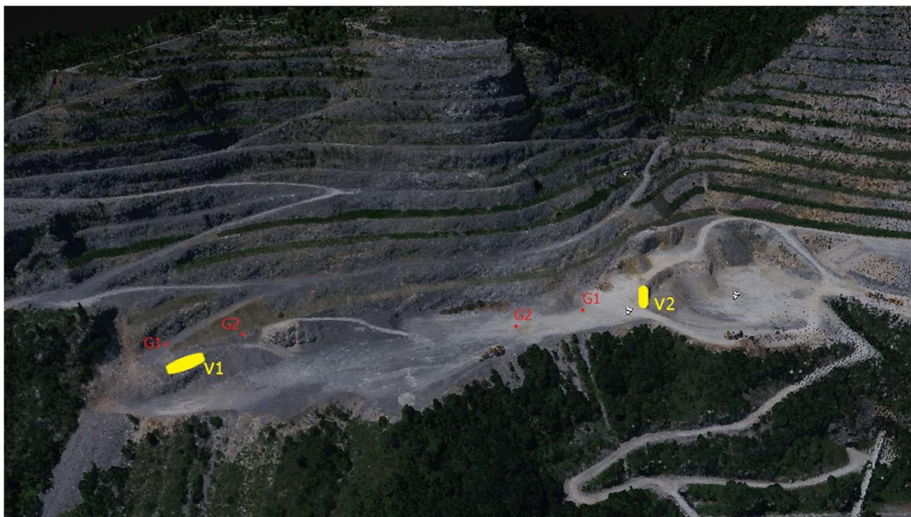
*Figura 60 - Schema di due differenti volate con il posizionamento delle stazioni di monitoraggio relative.*
