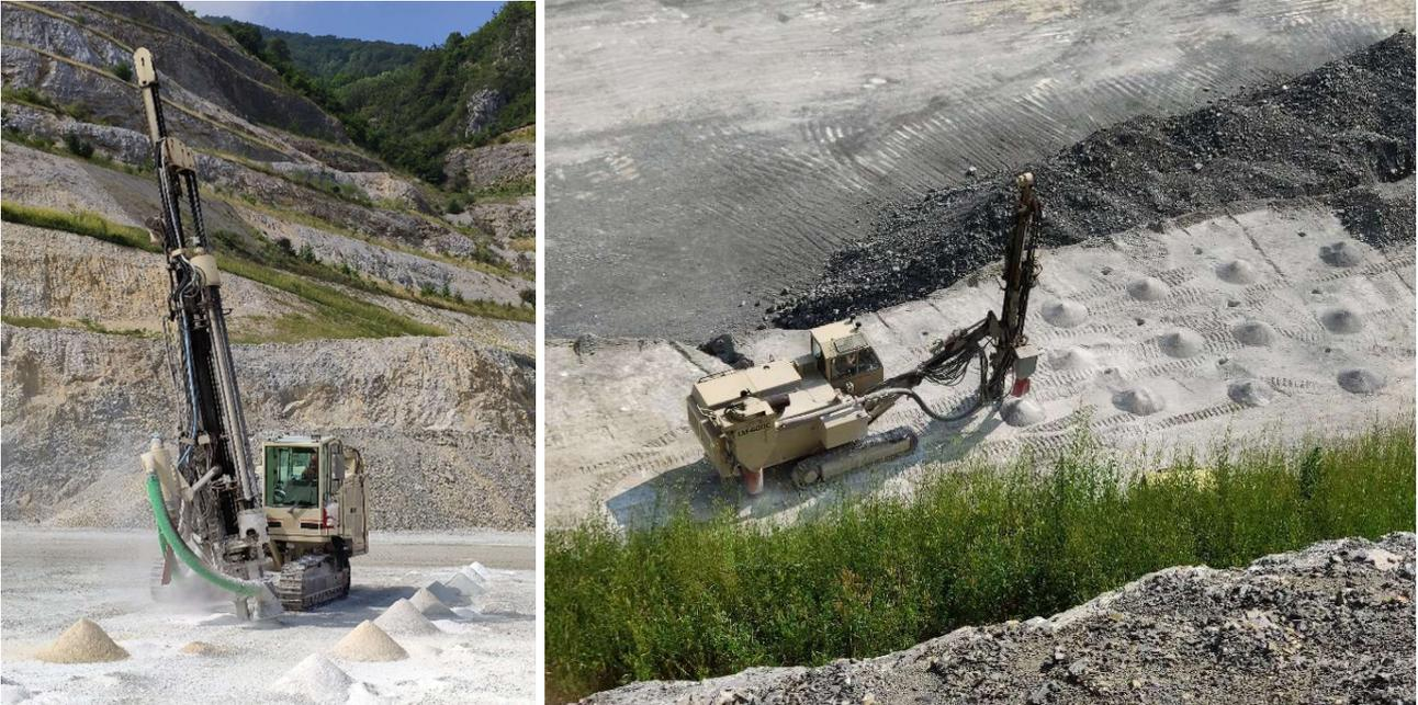
Figura 24 - A sinistra, vista frontale della perforatrice; a destra, vista dall'alto della fase di perforazione. Si nota il detrito di perforazione accanto ai fori.
