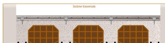
**Figura 5-37 Sezione tipo di solaio in laterocemento tramite interconnessione meccanica**
