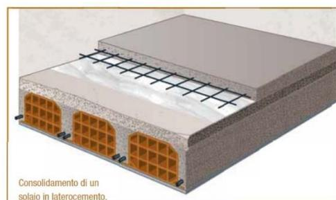
**Figura 5-40 Consolidamento tramite interconnessione chimica per solai in latero-cemento**
