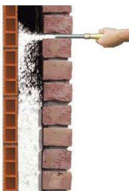
*Figura 5-32 Rappresentazione schematica sistema di insufflaggio*
