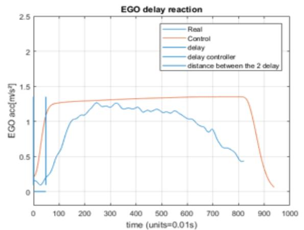
(d) Response Delay TOF Cut-Out - Manoeuvre 4
