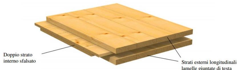
Anche in questo caso la composizione dell'edificio è scatolare, formata da elementi piani in X-Lam collegati tra loro. Un'ulteriore caratteristica della struttura in X-Lam è la sua grande flessibilità. La sua natura fatta di elementi strutturali massicci e piani permette infatti di realizzare:
