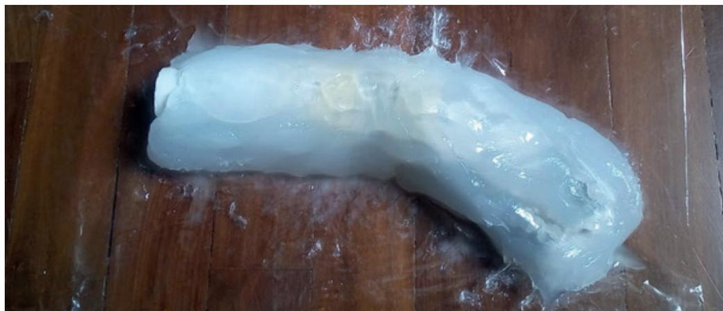
Si ottiene così, una volta indurito il silicone e rimosso opportunamente il calco di creta, uno **stampo che riprende esattamente la forma del calco** in tutte le sue parti e che verrà utilizzato per la colatura del materiale con cui sarà realizzato uno dei prototipi da presentare a Mario e Rudy.
