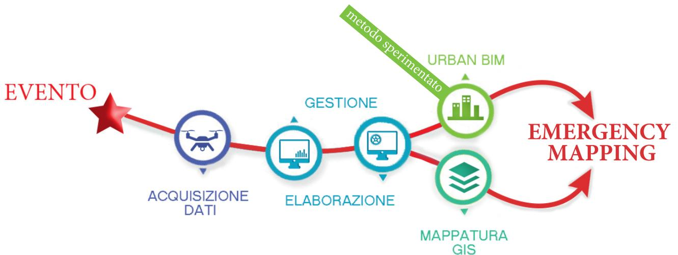
fig.2 - Workflow dell' *Emergency Mapping* con la fase sperimentale *Urban BIM*, come metodo aggiuntivo proposto.
