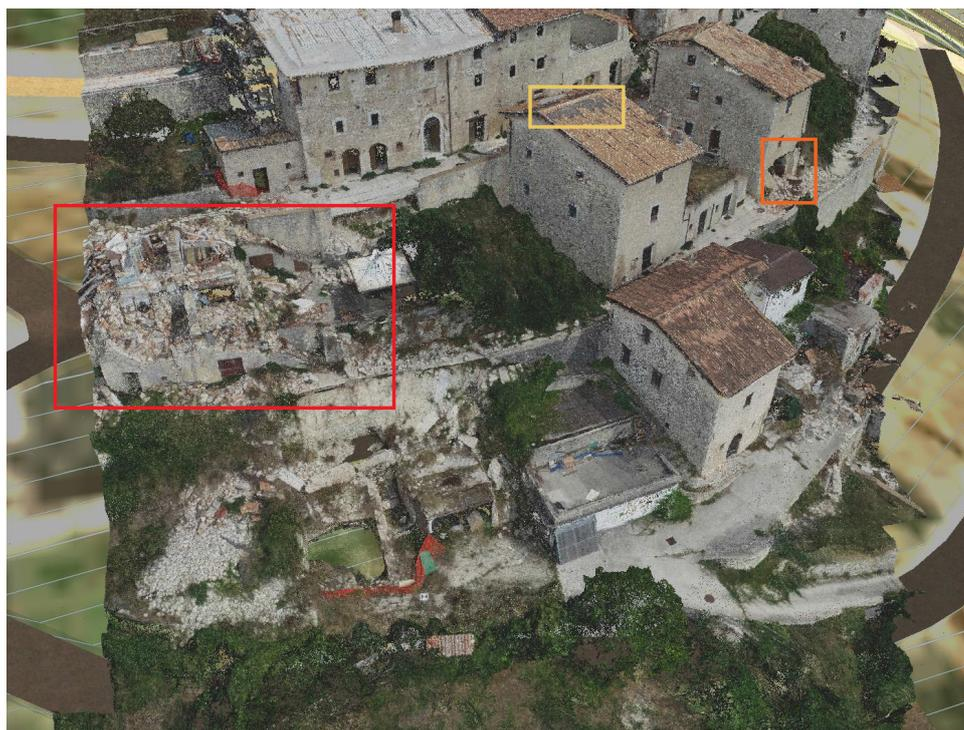
fig.14 - Immagine da Infraworks. Metodi di valutazione utilizzati per valutare il livello di danno.
