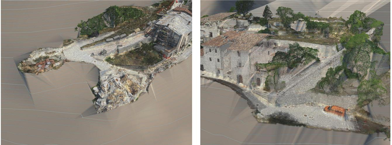
fig.11-12 Inserimento della nuvola di punti sull' orografia e generazione del nuovo terreno con i dati del rilievo.
