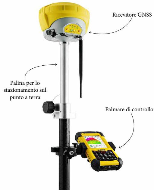
fig. 4 - Ricevitore GNSS. GEO-MAX Modello STONEX S10.
