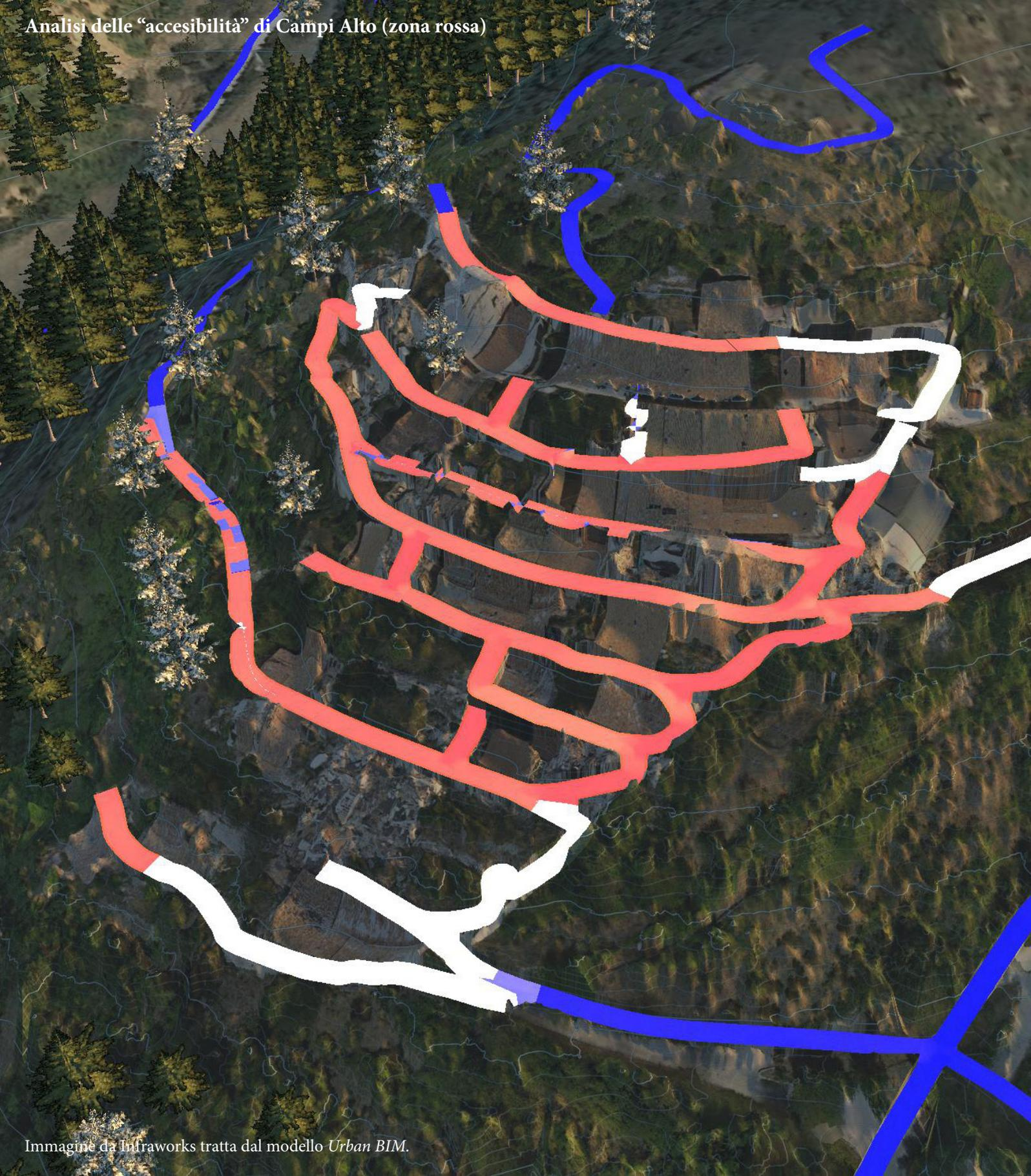
fig.25 - Immagine dell' U-BIM di Campi Alto tratta da *Infraworks*. Tematismi alla viabilità estratta dalla nuvola.
