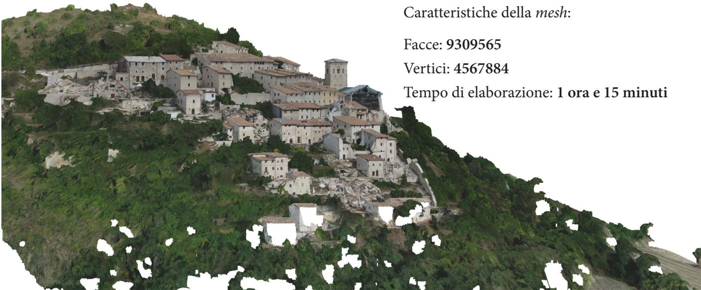
fig.18 - Ortomosaico del modello di Campi Alto. Lato sinistro. Risoluzione ( 23700 x 9042 - 18 mm/pix )
