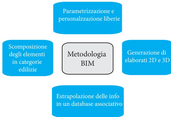
come lo intendiamo noi oggi, ovvero più che un software, è una metodologia. (fig.1). Il quale sta progressivamente sostituendo i sistemi di disegno CAD.
