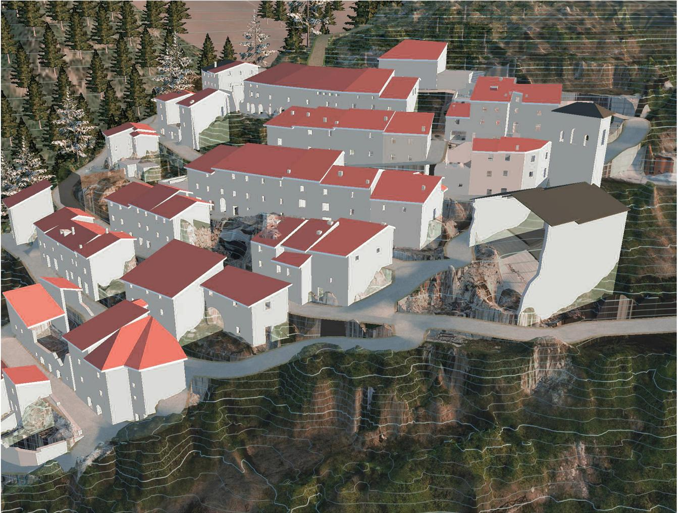
fig.22 - (Immagine da Infracore) Restituzione 3D del rilievo in LOD 3 attraverso i punti della nuvola.
