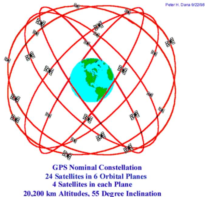
fig.3 - Orbite dei satelliti GPS.
