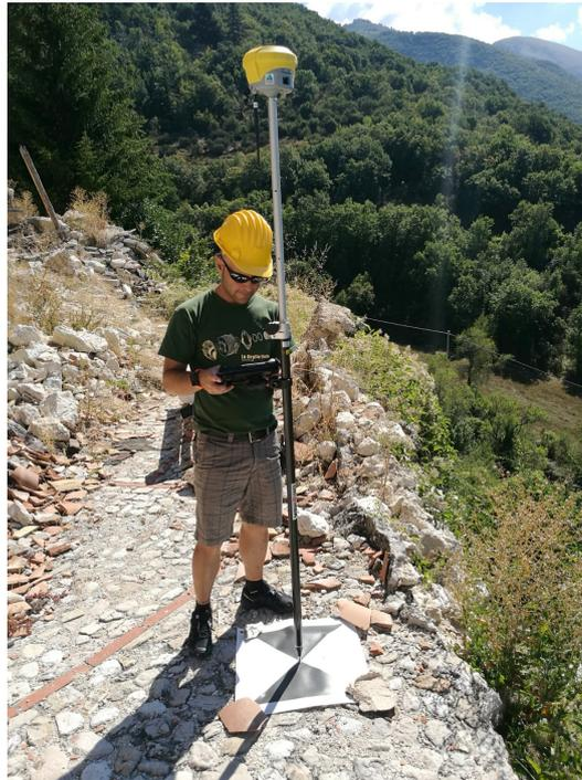
fig.5 - Target misurati con tecnica GPS/GNSS. Operatore con GEOMAX ZENITH 35 posizionato con palina su un marker della rete, per il ricevere le coordinate ellissoidiche da satellite. (Foto del Team)
