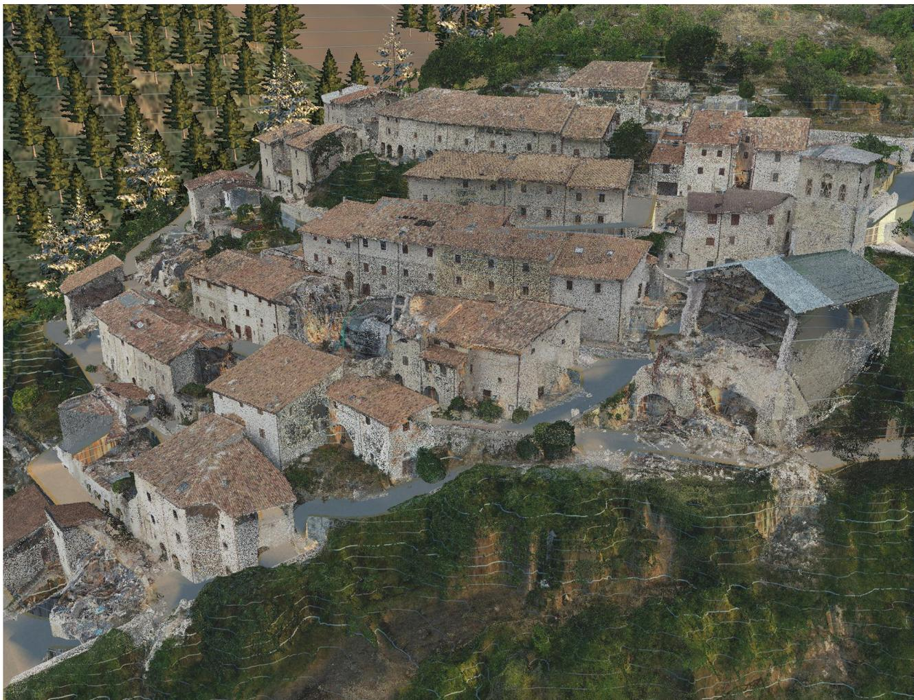
fig.21 - (Immagine da *Infraworks*) Nuvola di punti inserita nell' Urban BIM.
