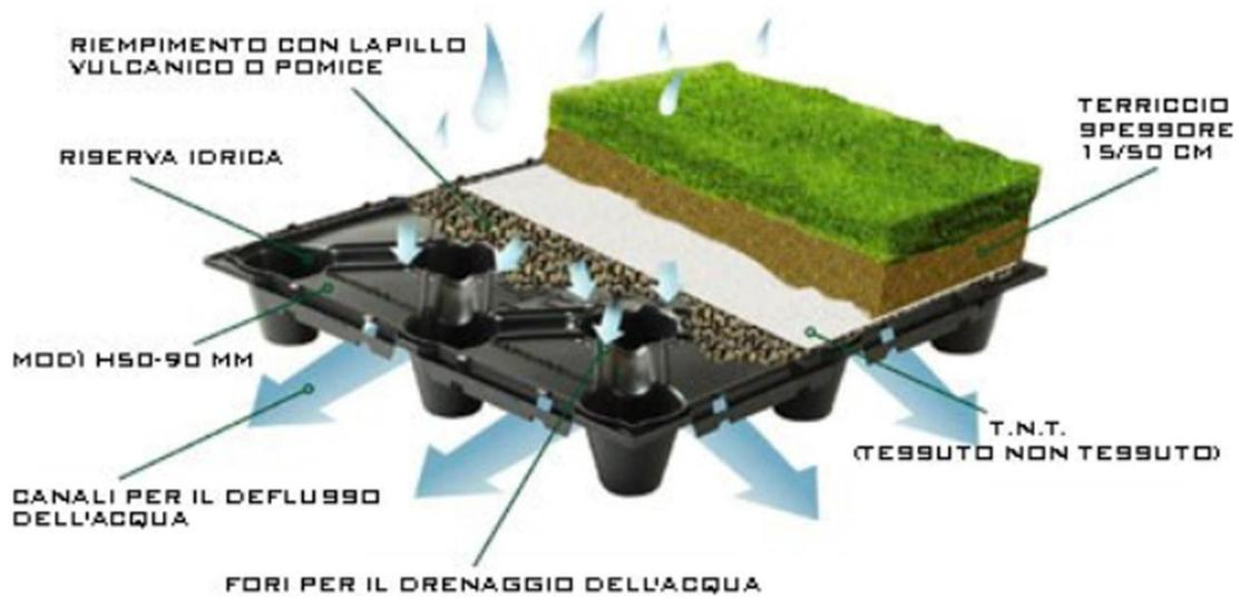
Figura 35 - Schema di un tetto verde/verde pensile.
