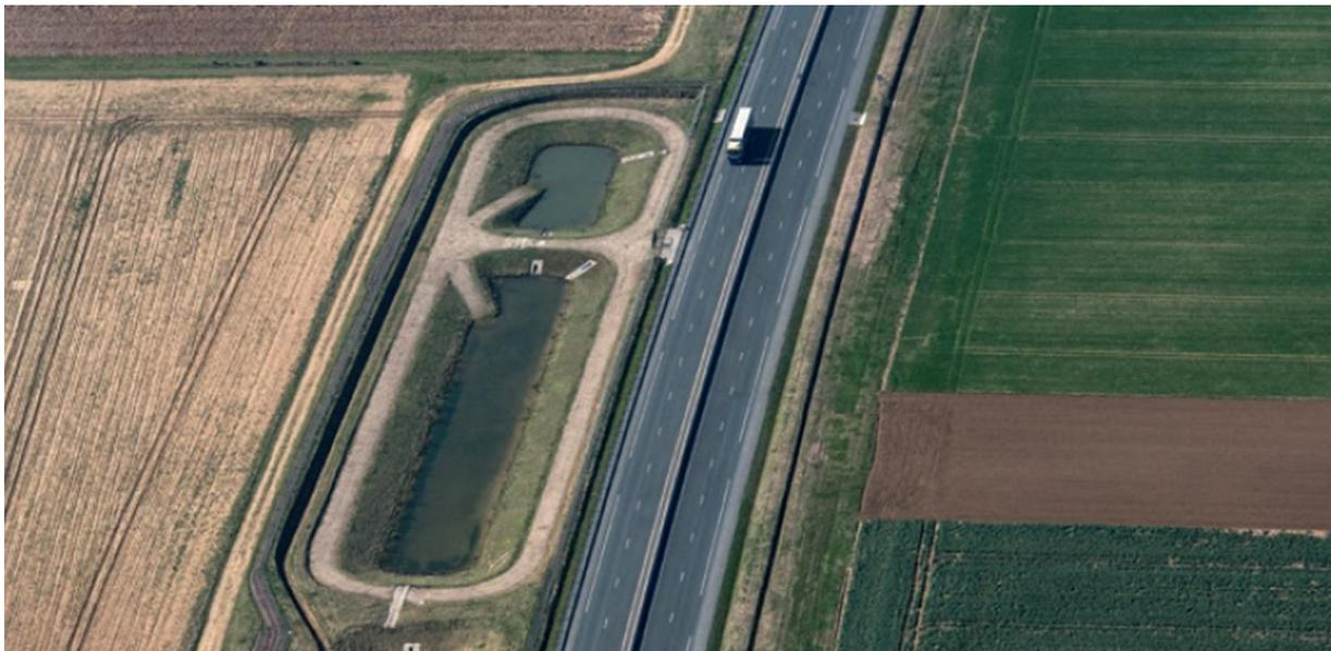
*Figura 28 - Esempio di un bacino di detenzione.
