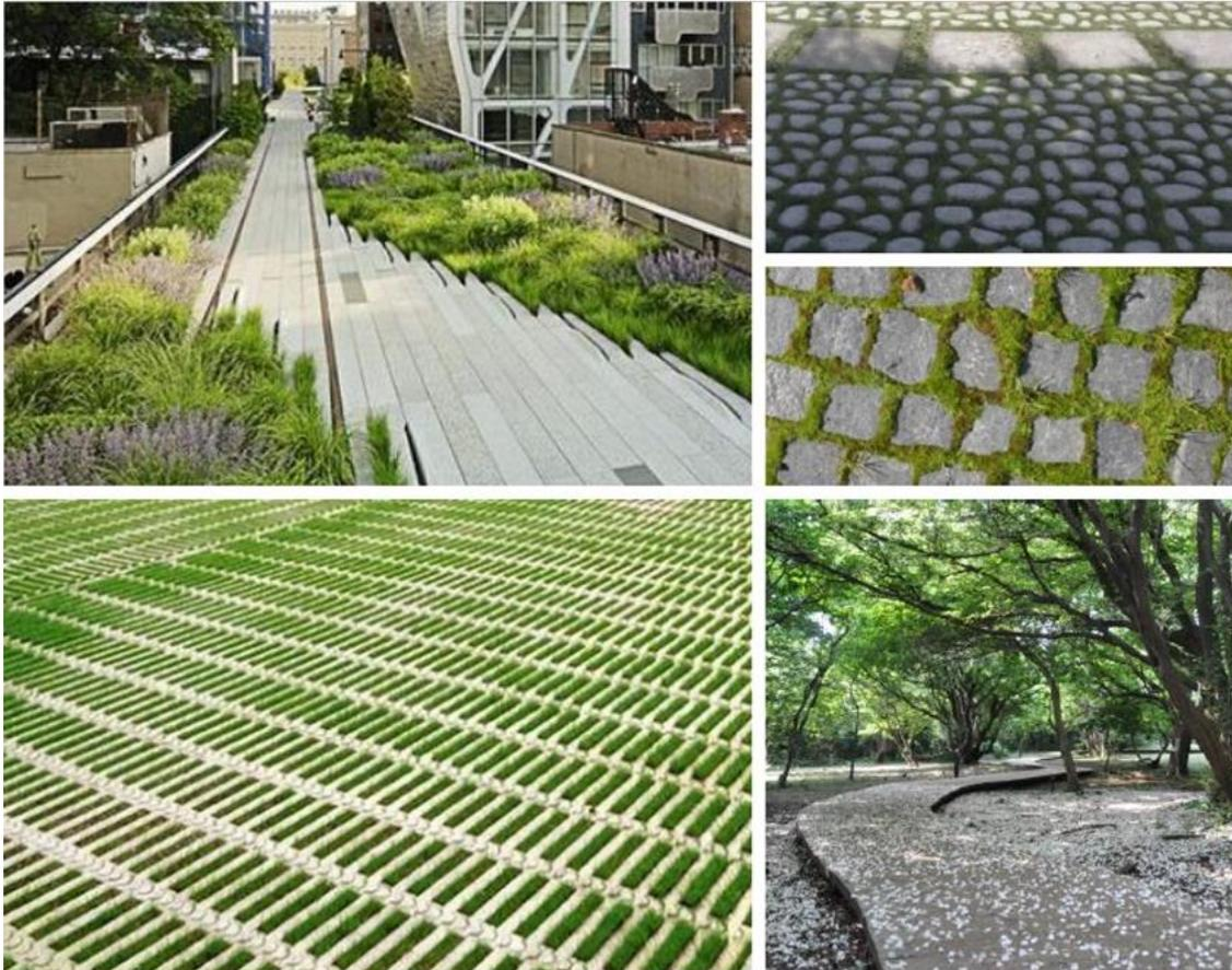
*Figura 34 - Esempi di pavimentazioni permeabili.
